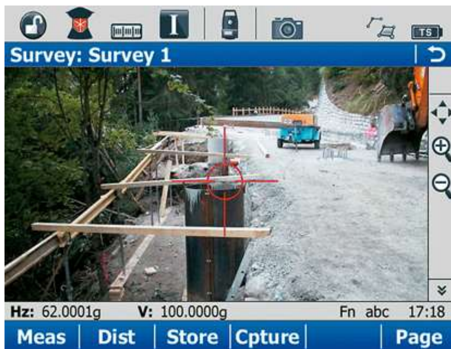
Рис. 2.8. Захват изображения, которое видит тахеометр
