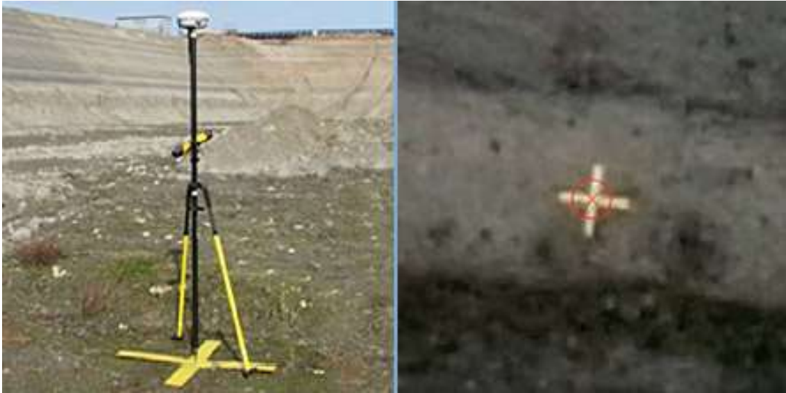
Рис. 1.36. Оповеститель для съемки беспилотным летательным аппаратом, координаты которого определены GPS-системой на земле (слева) и на снимке (справа)
