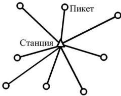
Рис. 2.16. Схема быстрой статической съемки
