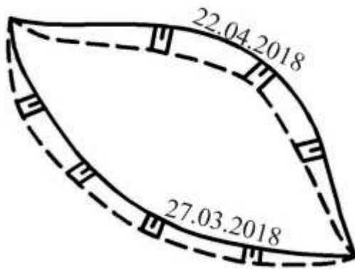
Рис. 4.2. Определение объема вскрыши в экскаваторном забое
