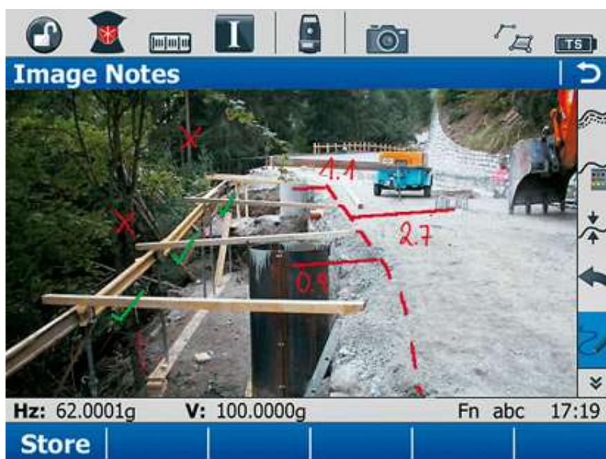
Рис. 2.9. Дополнение изображения рисованием и привязка изображения к известному объекту
