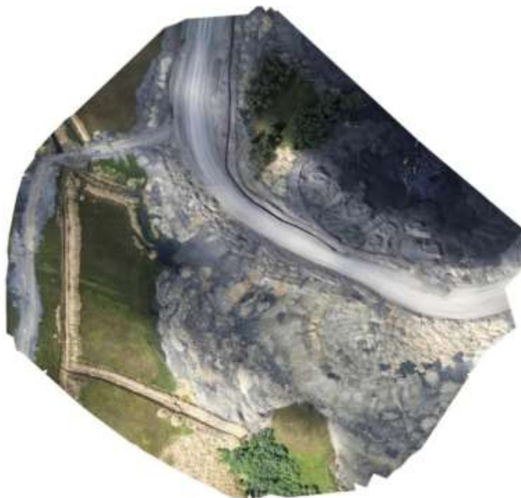
Рис. 2.36. Ортофотоплан угольного склада, сшитый по результатам съемки с беспилотного летательного аппарата
