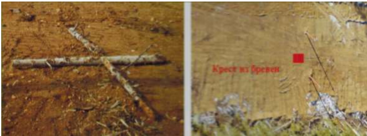
Рис. 1.37. Точка планово-высотного обоснования на земле (слева) и на снимке (справа) при высоте аэрофотосъемки 150 м
