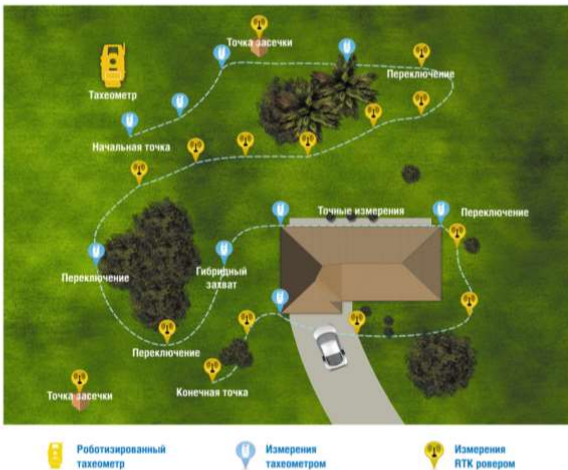
Рис. 2.24. Схема работы по технологии SmartPole/Hybrid
