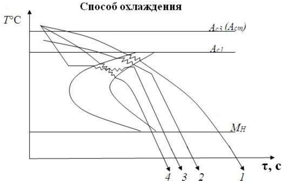
Рис. 3. График термических режимов отжига: 1 — полного; 2 — неполного; 3 — изотермического отжига; 4 — нормализации
