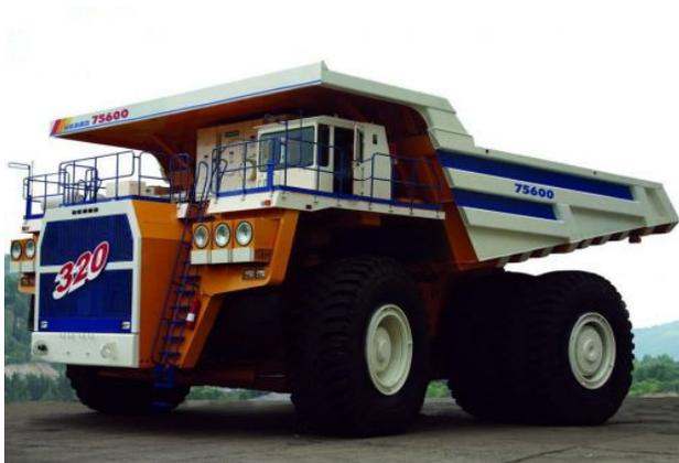
Карьерные самосвалы грузоподъемностью 320–360 т предназначены для перевозки горной массы в сложных горнотехнических условиях глубоких карьеров, на открытых разработках месторождений полезных ископаемых по технологическим дорогам в различных климатических условиях эксплуатации (при температуре окружающего воздуха от –50 до +50 град).
