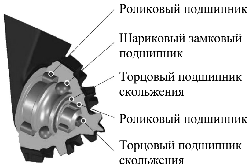
Рис. 3.22. Открытая опора типа В
