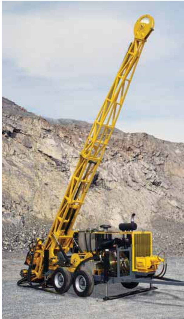
Рис. 2.19. Буровые установки CHRISTENSEN (CS) для открытых горных работ: a – на раме; б – на шасси
