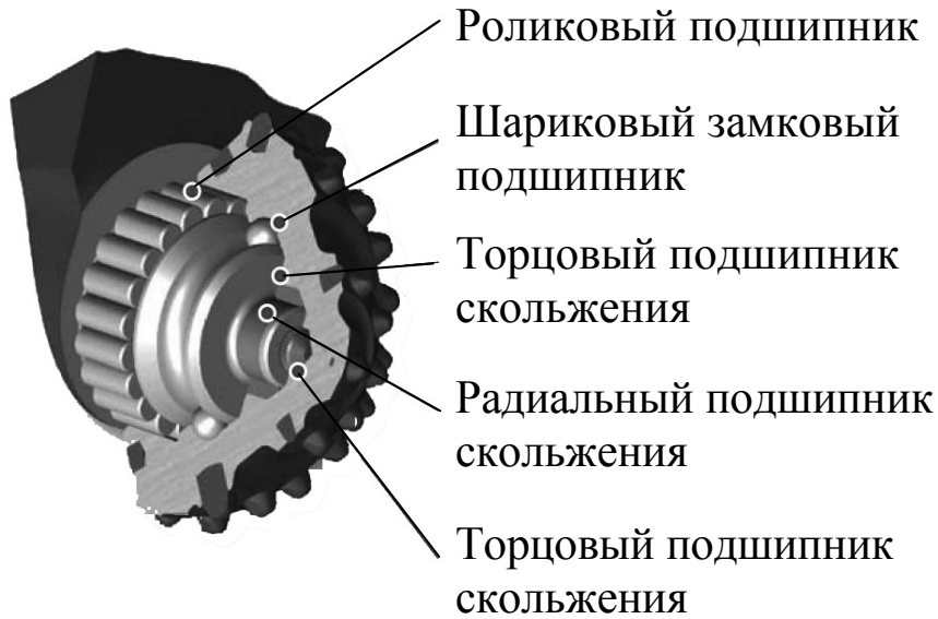
Рис. 3.21. Открытая опора типа Н
