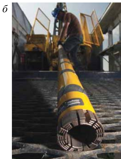
Рис. 3.44. Операции по извлечению кернов и демонтажу бурового става
