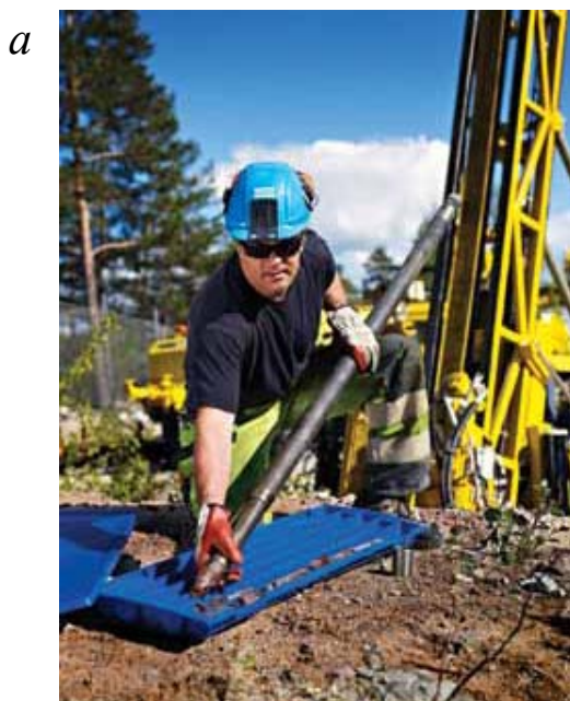
Рис. 3.44. Операции по извлечению кернов и демонтажу бурового става
