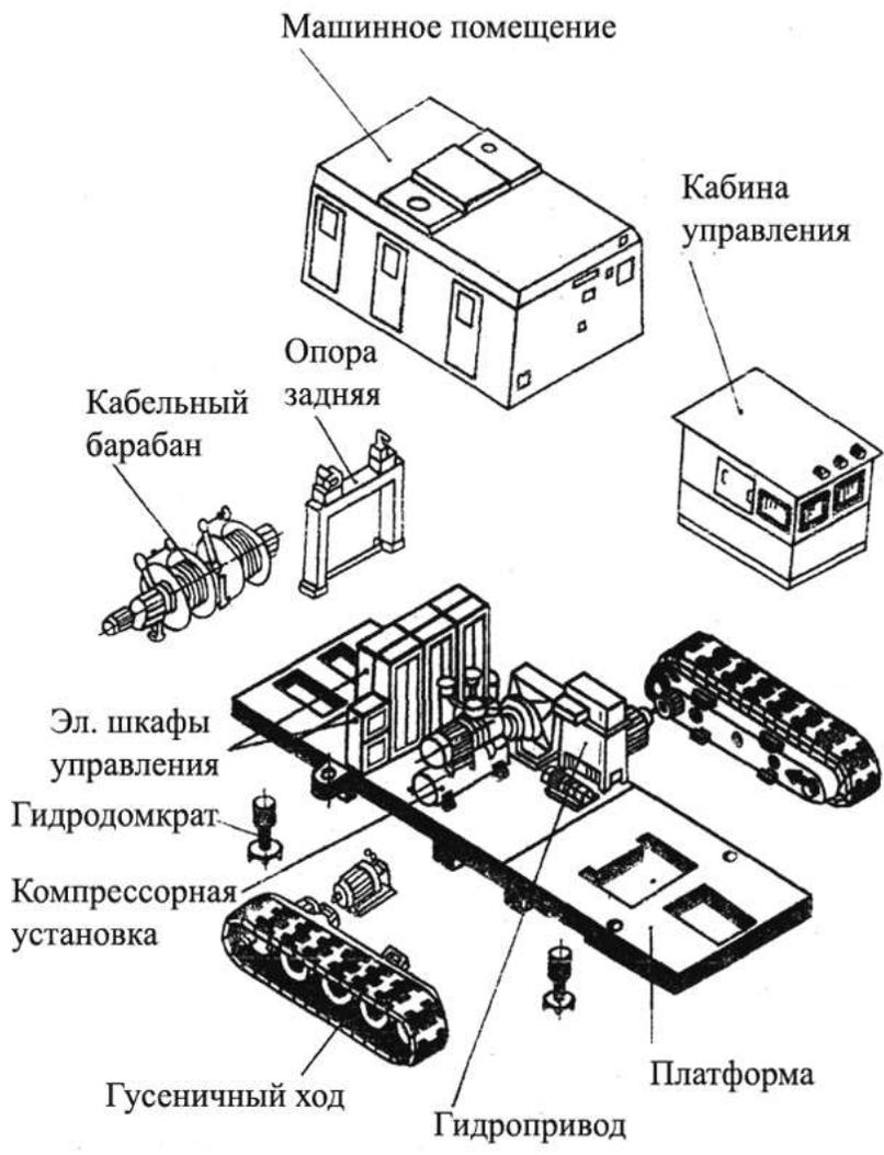
Рис. 2. Схема расположения оборудования
