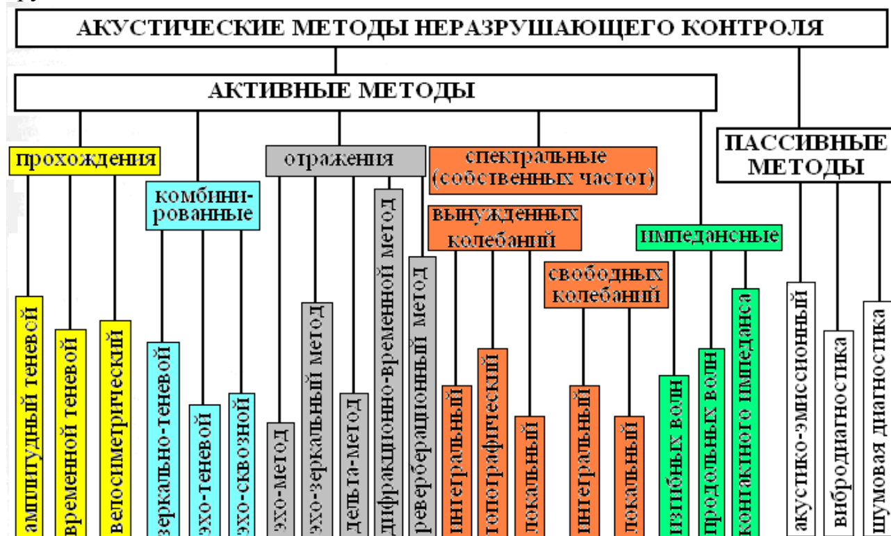
Рисунок 7. Классификация акустических методов контроля
