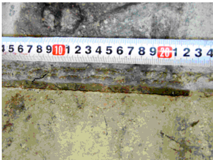
Рисунок 4. Непровар в корне шва
