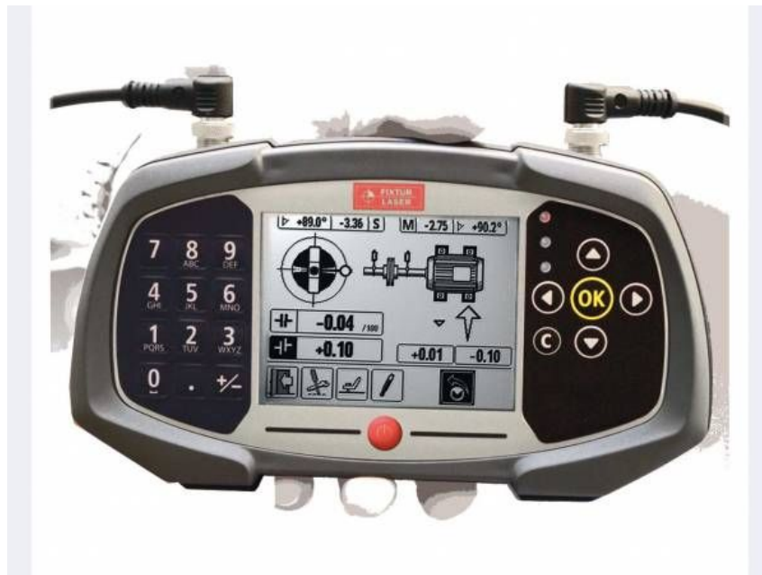
Рисунок 16. Лазерный центровщик FixturlazerGO фирмы Pruftechnik
