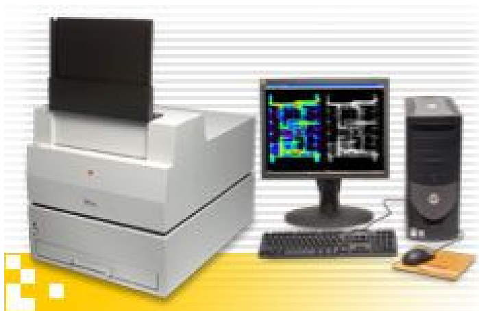
Рисунок 18. Комплекс цифровой радиологии ФОСФОМАТИК
