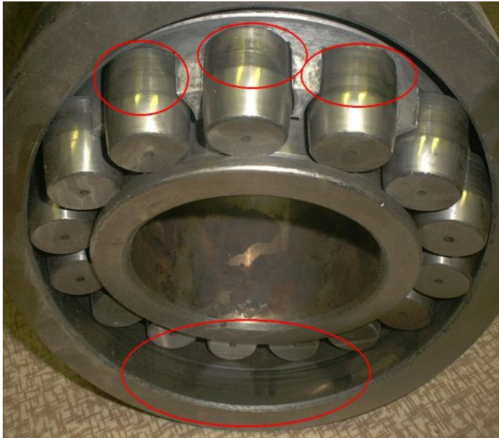
Рисунок 12. Дефекты тел качения и беговой дорожки переднего подшипника вращателя
