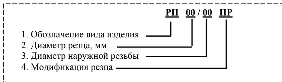
Рис. 8.2. Расшифровка обозначения буровых резцов
