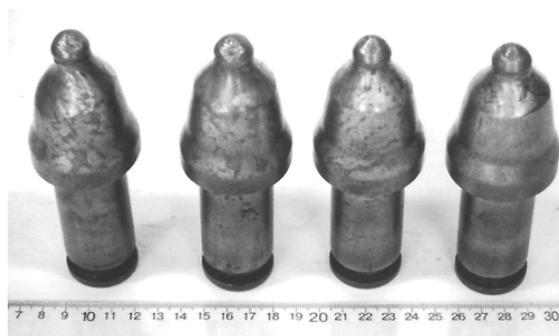
*Рис. 17.10. Характерная сеть мелких трещин в армировке резца РШ32-70/16SK*
