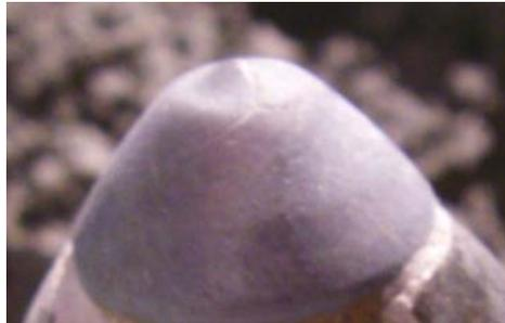
Рис. 14.24. Выкрашивание вершины режущей вставки
