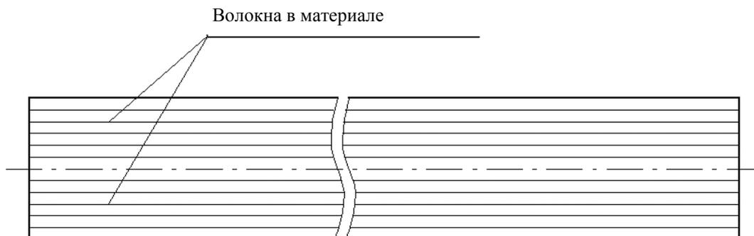
Рис. 13.6. Макроструктура материала перед обработкой
