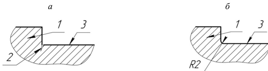
Рис. 14.10. Зона перехода головной части в хвостовую:
