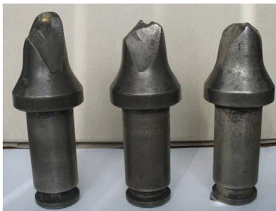
*Рис. 14.8. Скалывание головной части резца с потерей вставки, шахта Первомайская, 2005 г.*
