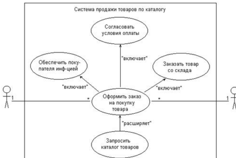
Рис. 13. Уточненный вариант диаграммы вариантов использования для примера системы продажи товаров по каталогу
