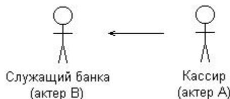
Рис. 10. Пример графического изображения отношения обобщения между актерами
