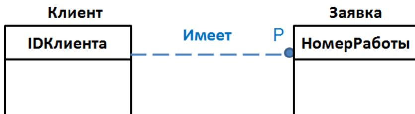
Рис. 2. Пример установления связи 1:n между сущностями
