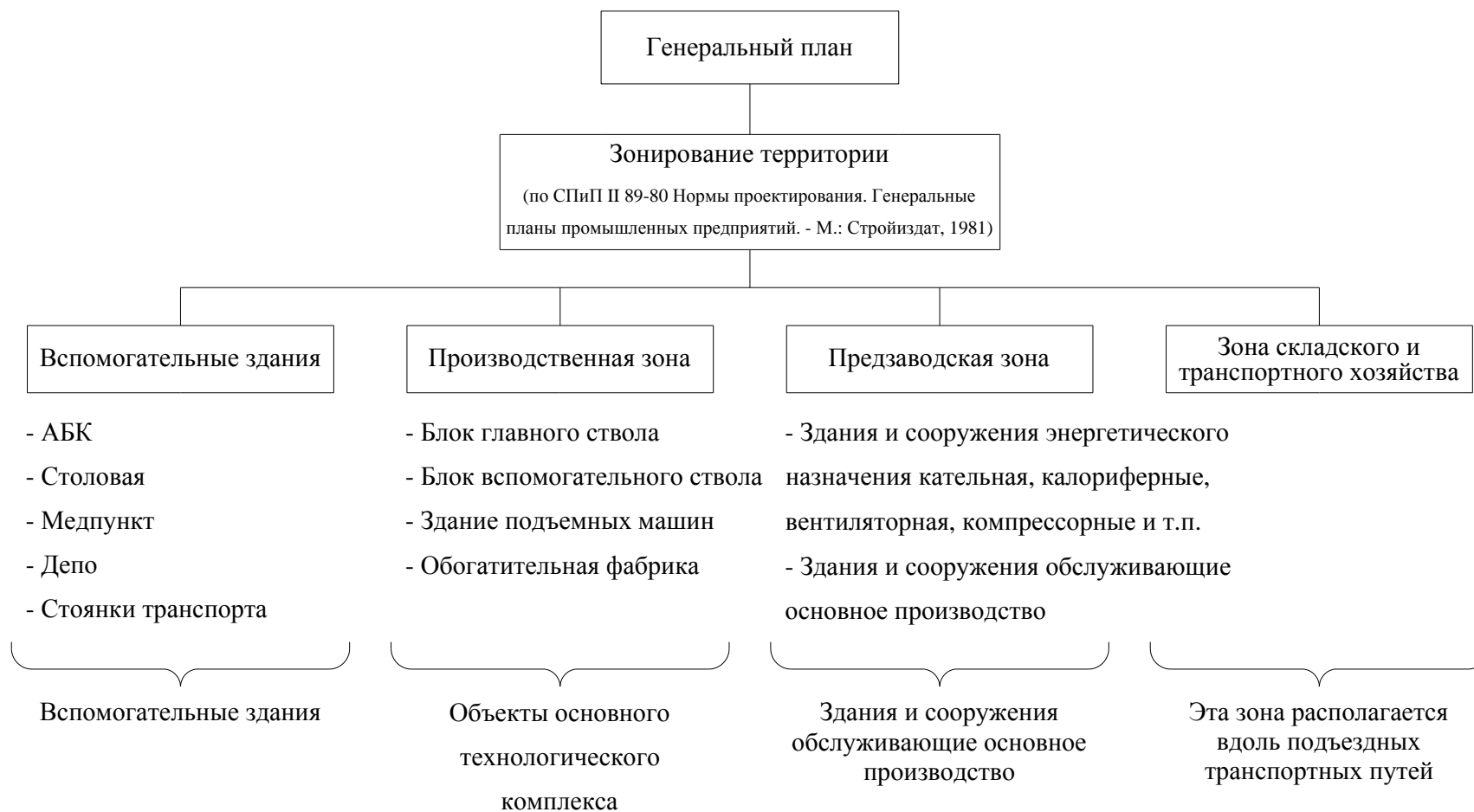
Рисунок 5.1 – Основные принципы построения генерального плана шахты
