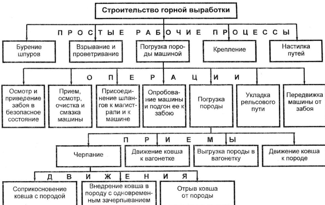
Рисунок 3.4 – Технологический процесс строительства горной выработки
