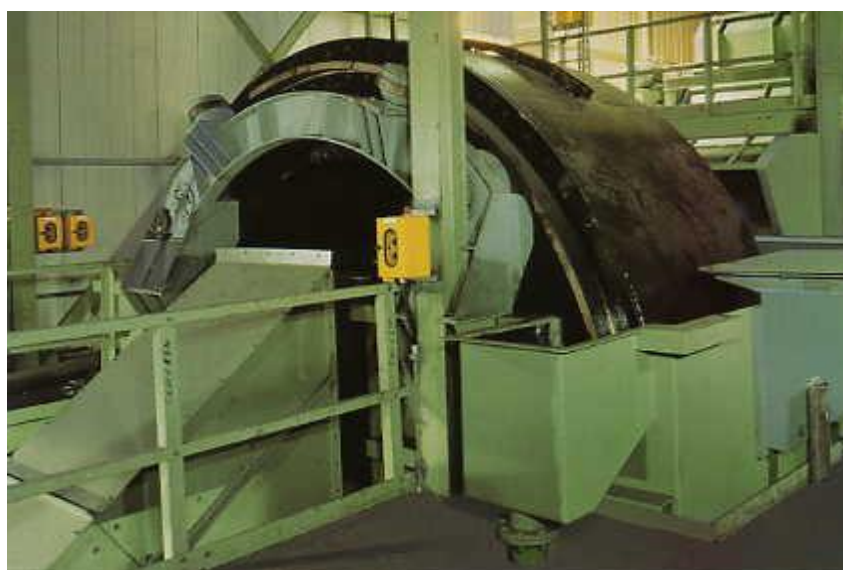
Рис. 3.1.3.3.2. Отсадочная машина с подвижным решетом РОМДЖИГ (KHD HUMBOLDT WEDAG)
