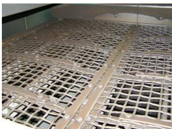
Рис. 2.1.5.1.3. Сита – проволочные сетки – тканые и плетенные
