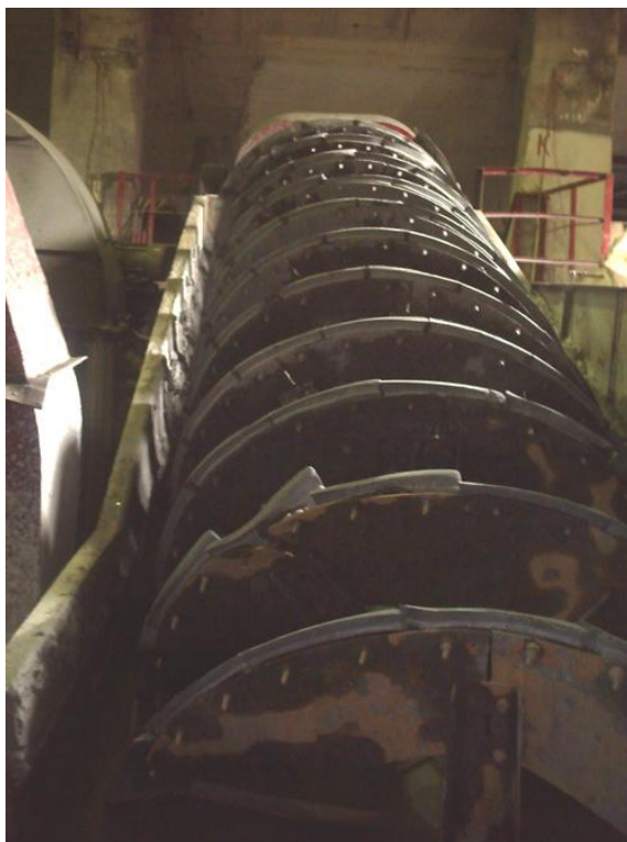
Рис. 2.2.1.1. Механический спиральный классификатор с непогруженной спиралью
