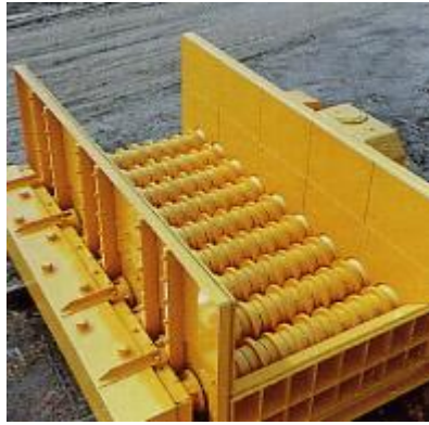
Рис. 2.1.5.3.1. Валковый (роликовый) грохот
