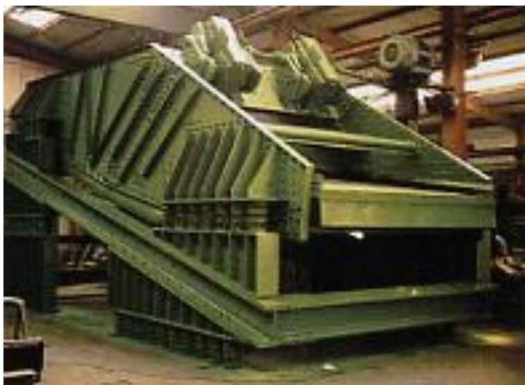
Рис. 4.1.3.1. Грохот инерционный с самобалансным самосинхронизирующимся вибратором.
