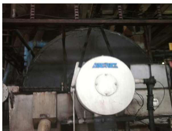
Рис. 4.1.6.3. Дисковые вакуум-фильтры фирмы «ANDRITZ» на Беловской ЦОФ
