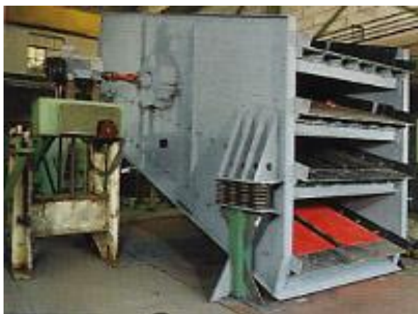
Рис. 2.1.1.1. Грохот с каскадным расположением сит
