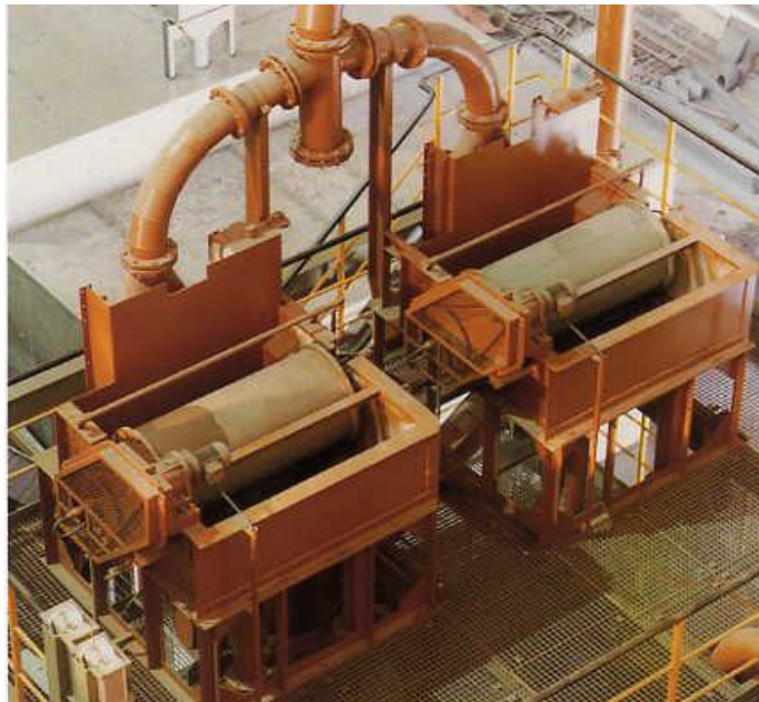
Рис. 3.3.1.2. Барабанный сепаратор с постоянными магнитами для регенерации магнетитовой суспензии
