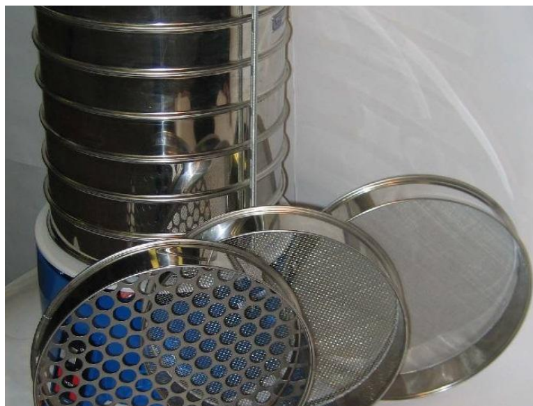
Рис. 2.1.3.1. Стандартный набор сит для ситового анализа
