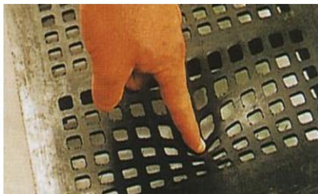
Рис. 2.1.5.1.2. Решета из полимерных материалов
