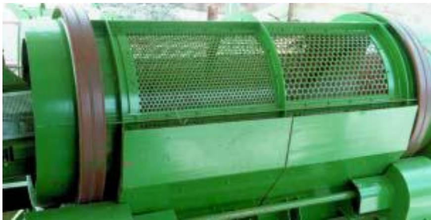
Рис. 2.1.5.3.2. Барабанный грохот Lindemann
