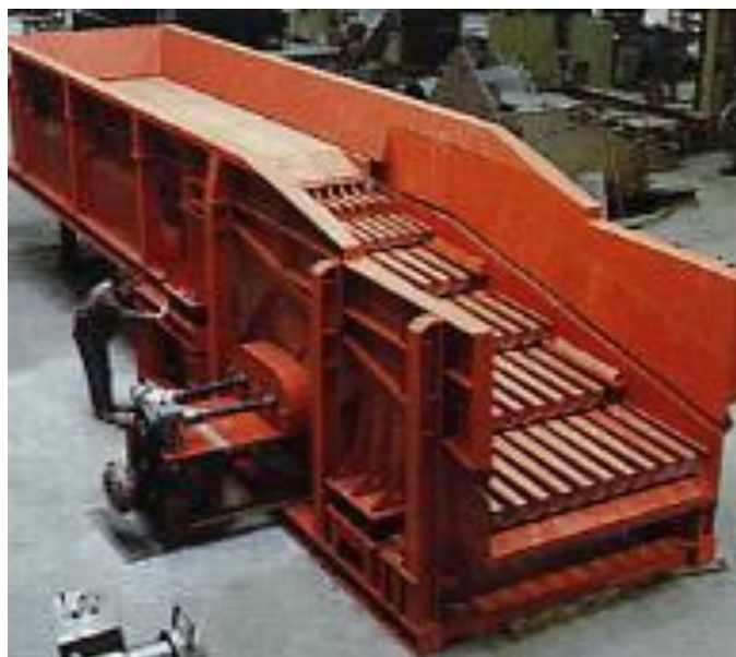
Рис. 2.1.1.2. Грохот с последовательным расположением сит
