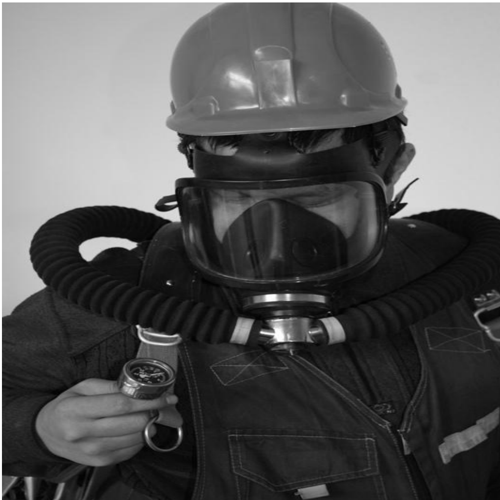
Рис. 25. Наблюдение за шкалой манометра при оттягивании его от груди вместе с концевым ремнем
