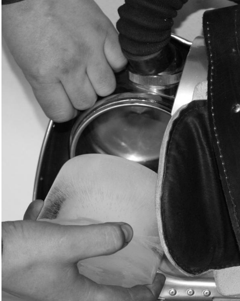
Рис. 26. Снаряжение холодильника охлаждающим элементом без снятия респиратора
