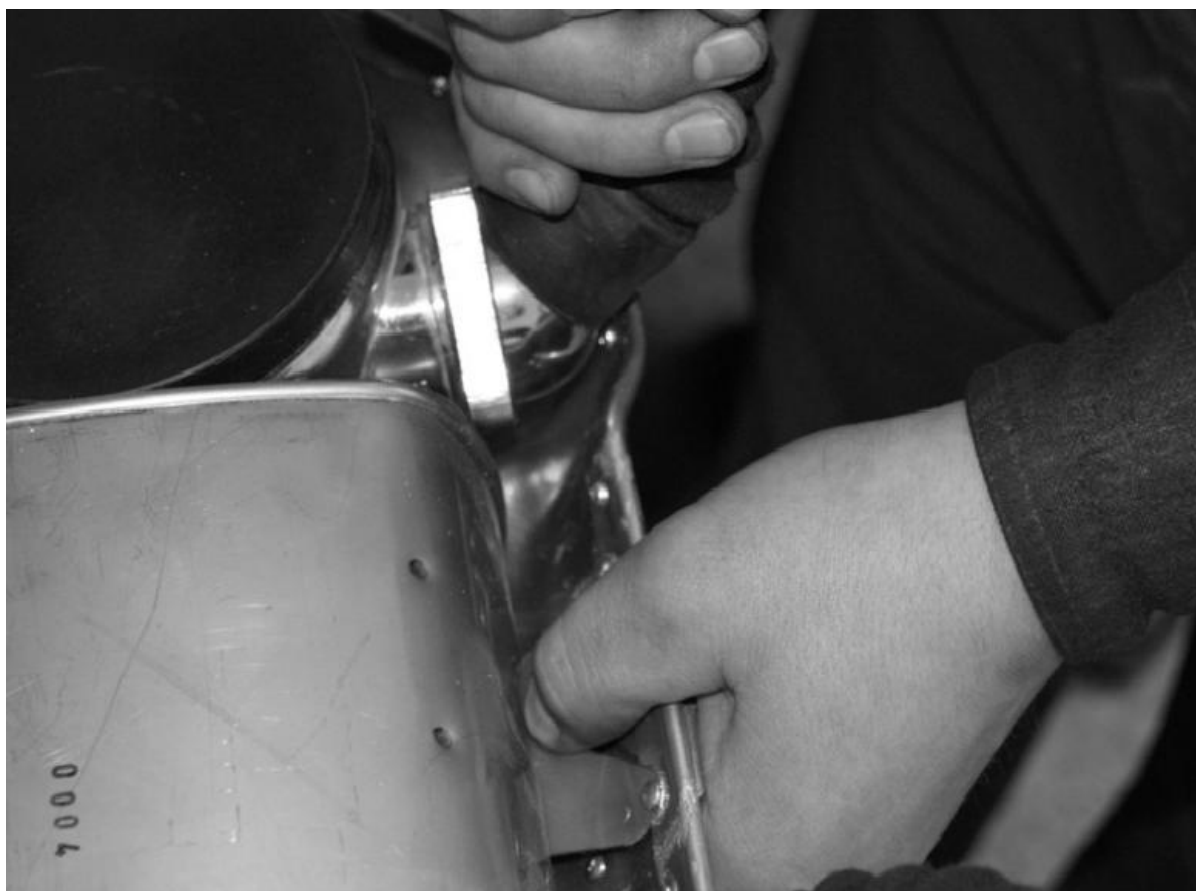
Рис. 21. Освобождение регенеративного патрона от фиксирующей защелки
