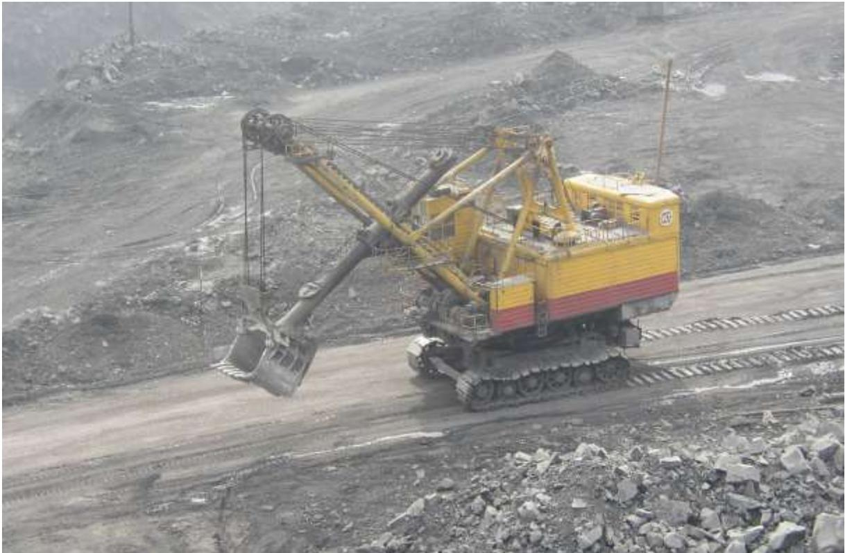
Рис. 5.1. Мехлопата ЭКГ-8И во время перегона
