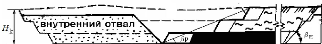
Рис. 2.35. Схема разработки горизонтального месторождения с размещением пород вскрыши во внутреннем отвале
