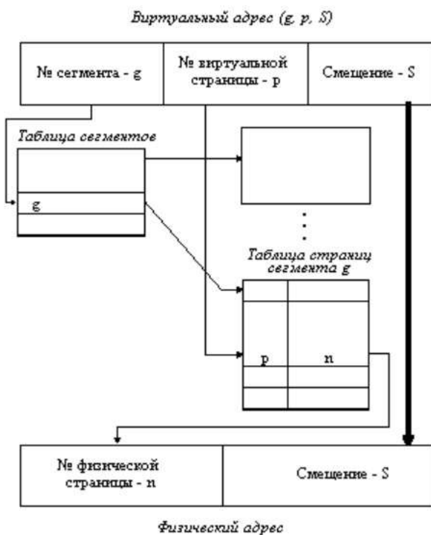
Рисунок 7 – Схема преобразования виртуального адреса в физический для сегментно-страничной организации памяти
