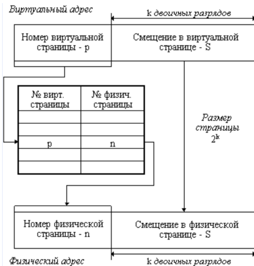
Рисунок 5 – Механизм преобразования виртуального адреса в физический при страничной организации памяти
