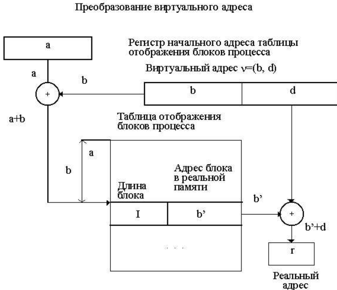
Рисунок 5 – Преобразование виртуального адреса
