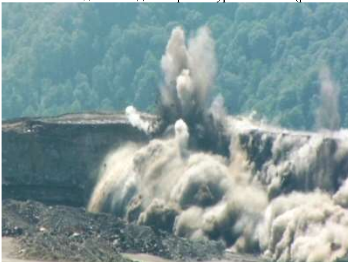
Рис. 1.14. Взрывание однорядных наклонных заоткашивающих скважин по проектному контуру на всю высоту уступа при выемке последней заходки в приконтурной полосе
