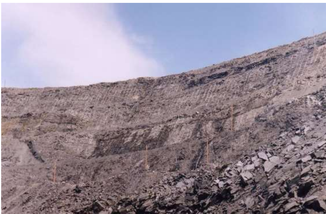
Рис. 1.16. Оформление откоса группы уступов на подходе к предельному контуру карьера
