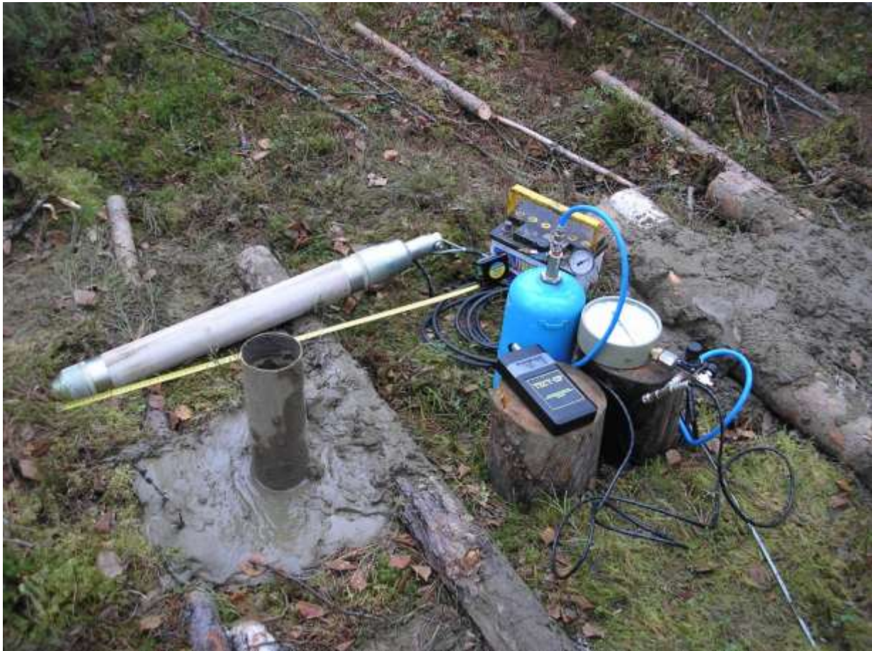
Рис. 4.8. Полевые испытания пород прессиомером
