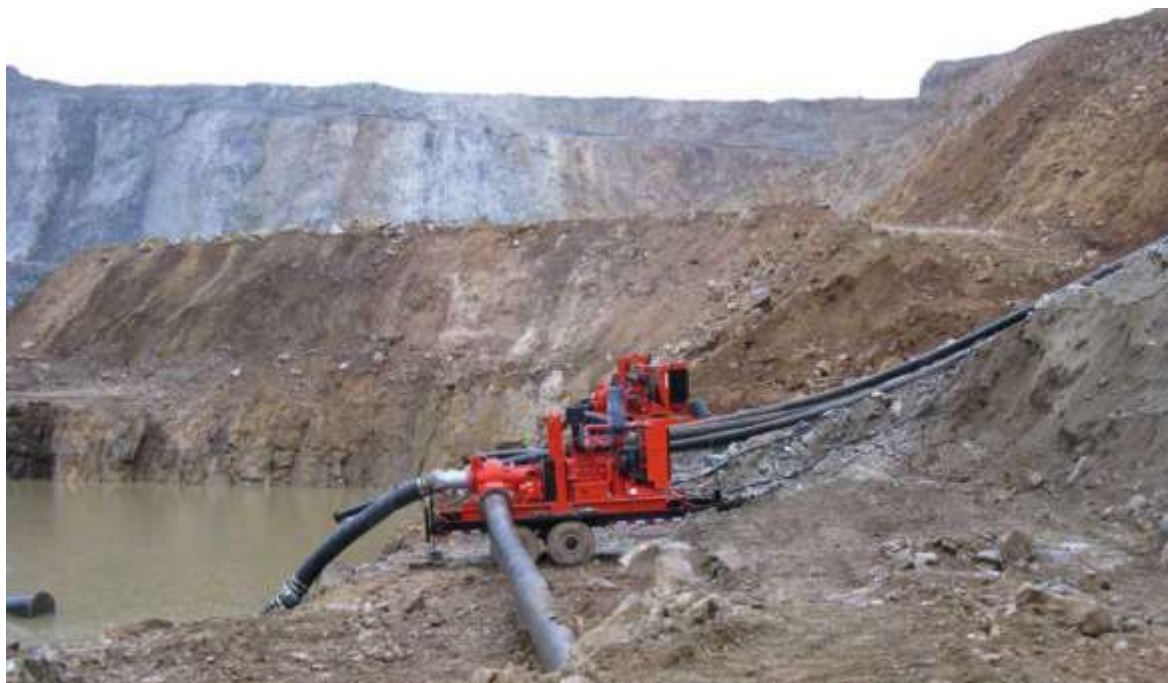
Рис. 2.8. Откачка воды из зумпфа с помощью передвижных транспортируемых насосных станций: а – на салазках; б – на колесах
