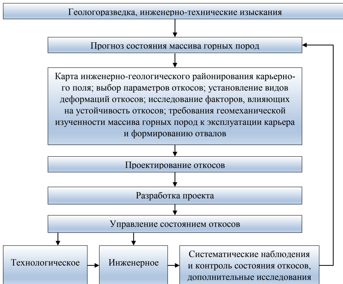
Рис. 5.1. Последовательность исследования, проектирования и управления устойчивостью откосов карьеров
