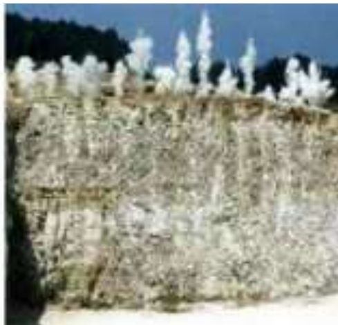
Рис. 1.13. Взрывание с предварительным щелеобразованием на предельном контуре карьера наклонными скважинами на высоту одного (а) и нескольких (б) уступов
