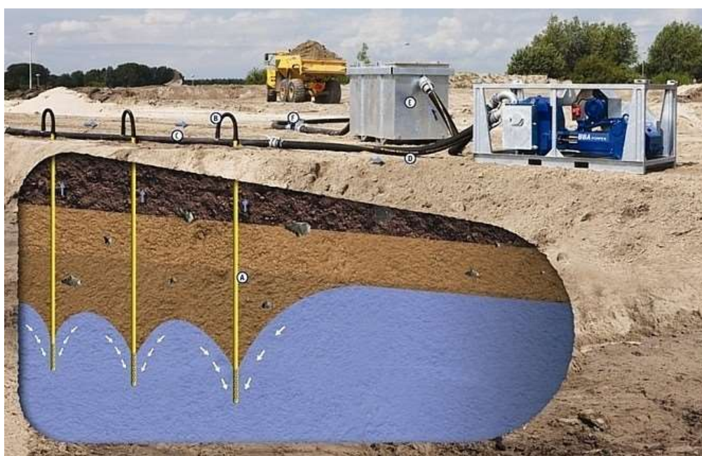
Рис. 2.20. Игольчатые фильтры: а – передвижные; б – легкие
