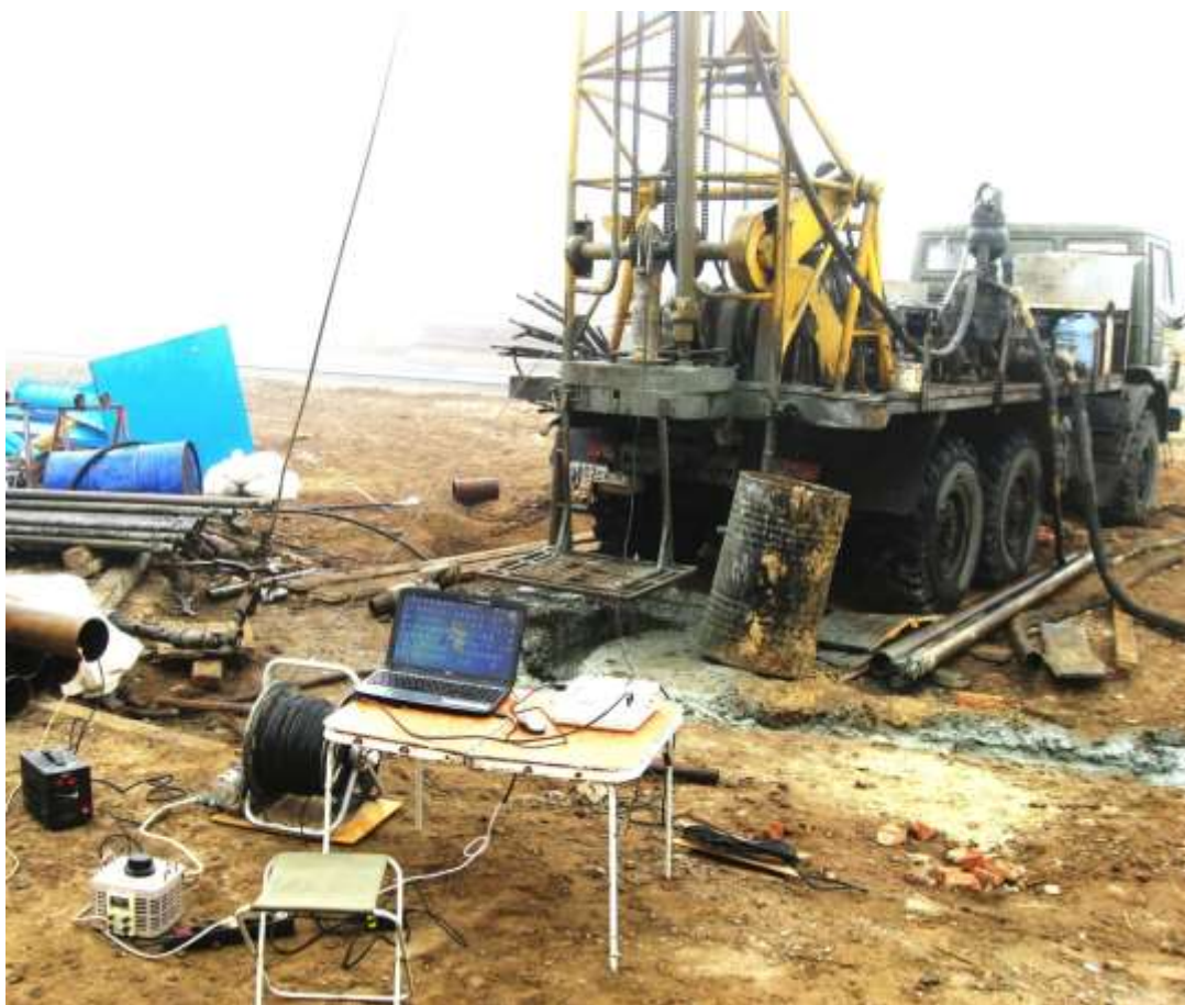
Рис. 4.9. Станция пенетрационная телеметрическая каротажная (СПТК)
