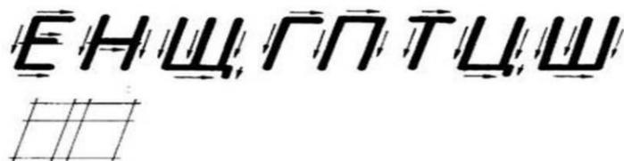
Рис. 138. Начертание прописных букв, состоящих из горизонтальных и вертикальных элементов, и построение вспомогательной сетки
