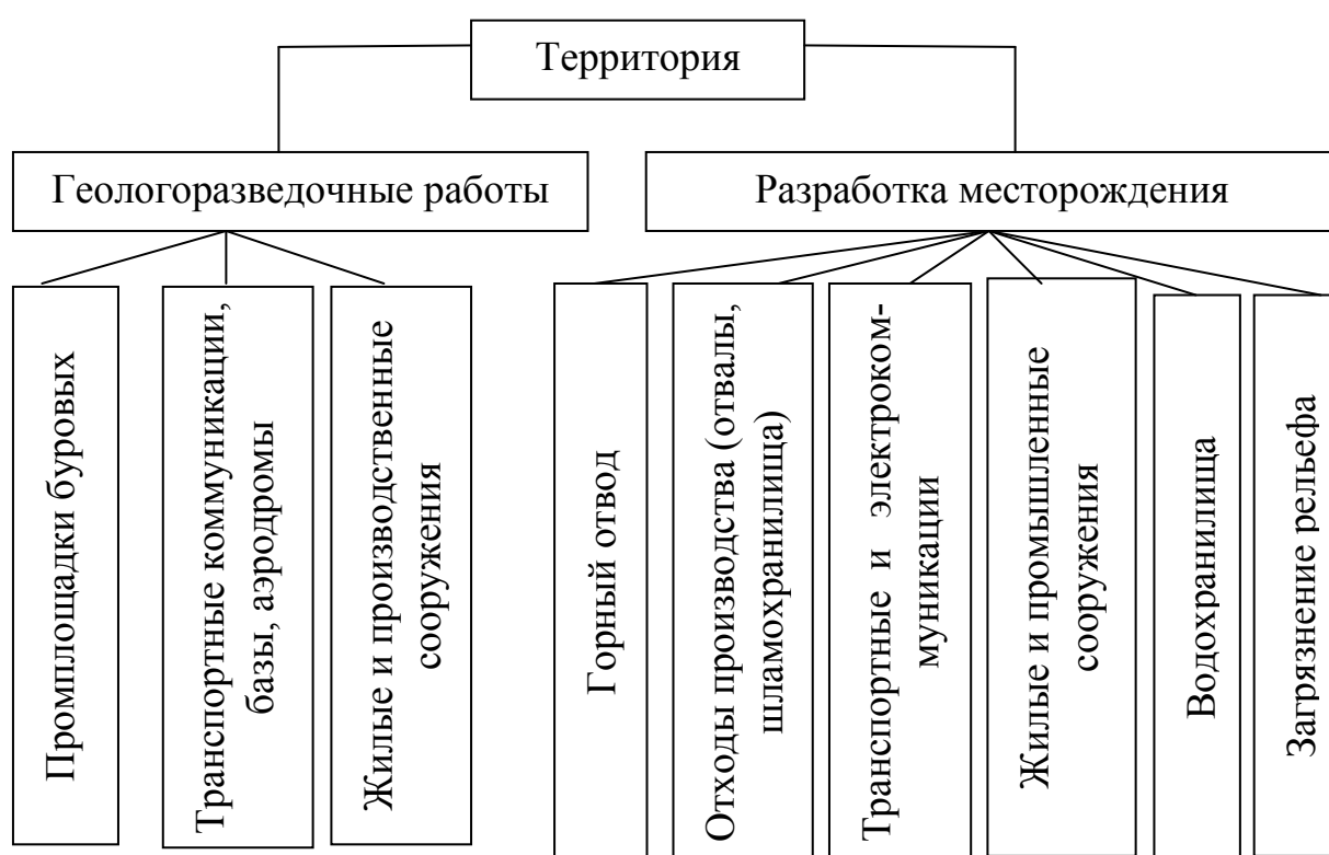
Рис. 4.1. Схема нарушения территорий при разведке и разработке месторождений
