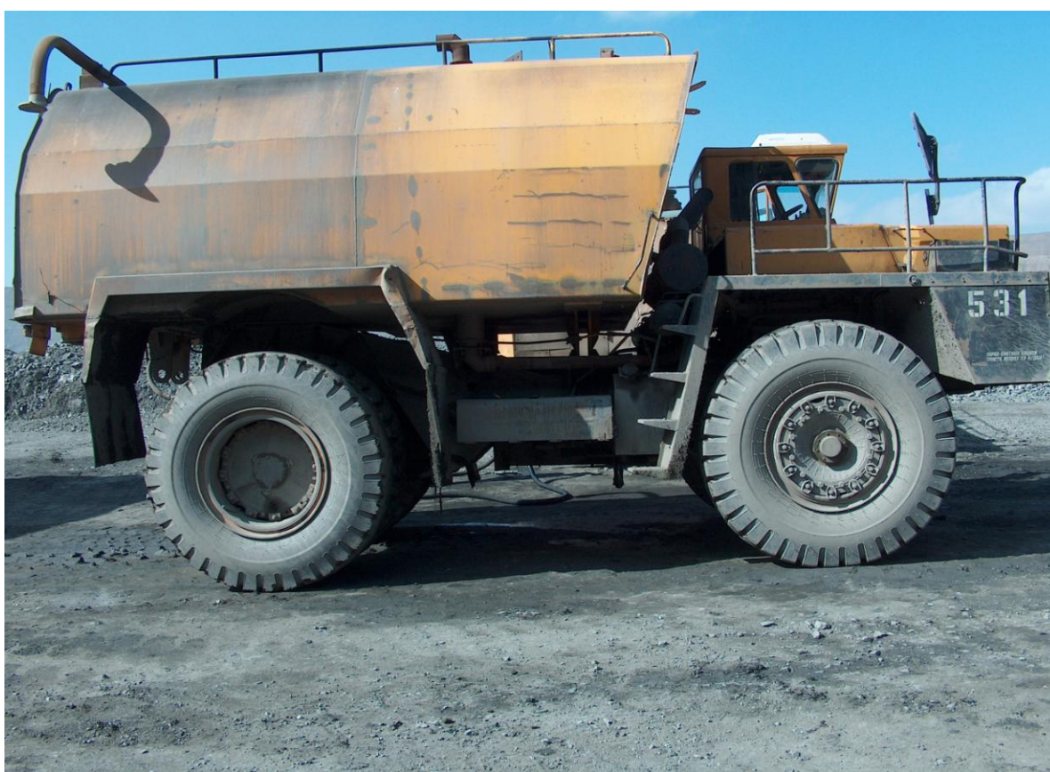
Рис. 2.15. Поливочная машина на базе БелАЗ-7548
