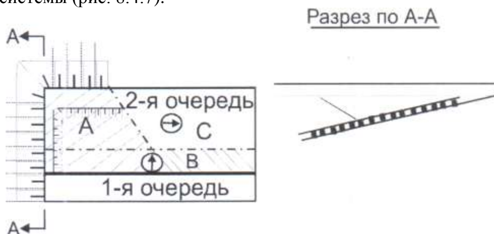
Рис. 8.4.7. Технология отработки карьерного поля с применением КГРП
