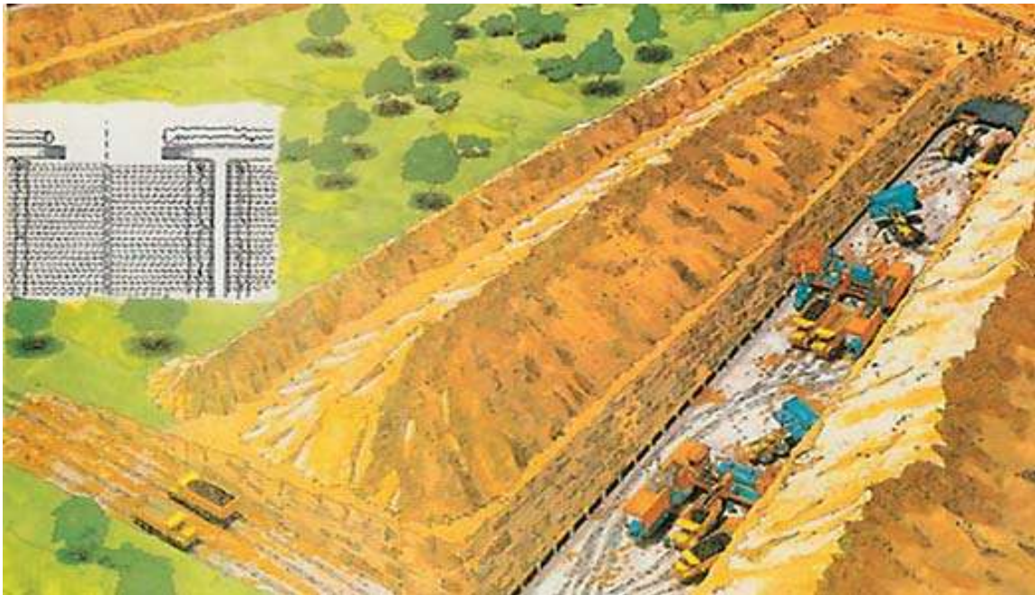
Рис. 8.4.3. Вскрытие и подготовка разрезной траншеи угольного пласта для КГРП (технология КГРП)
