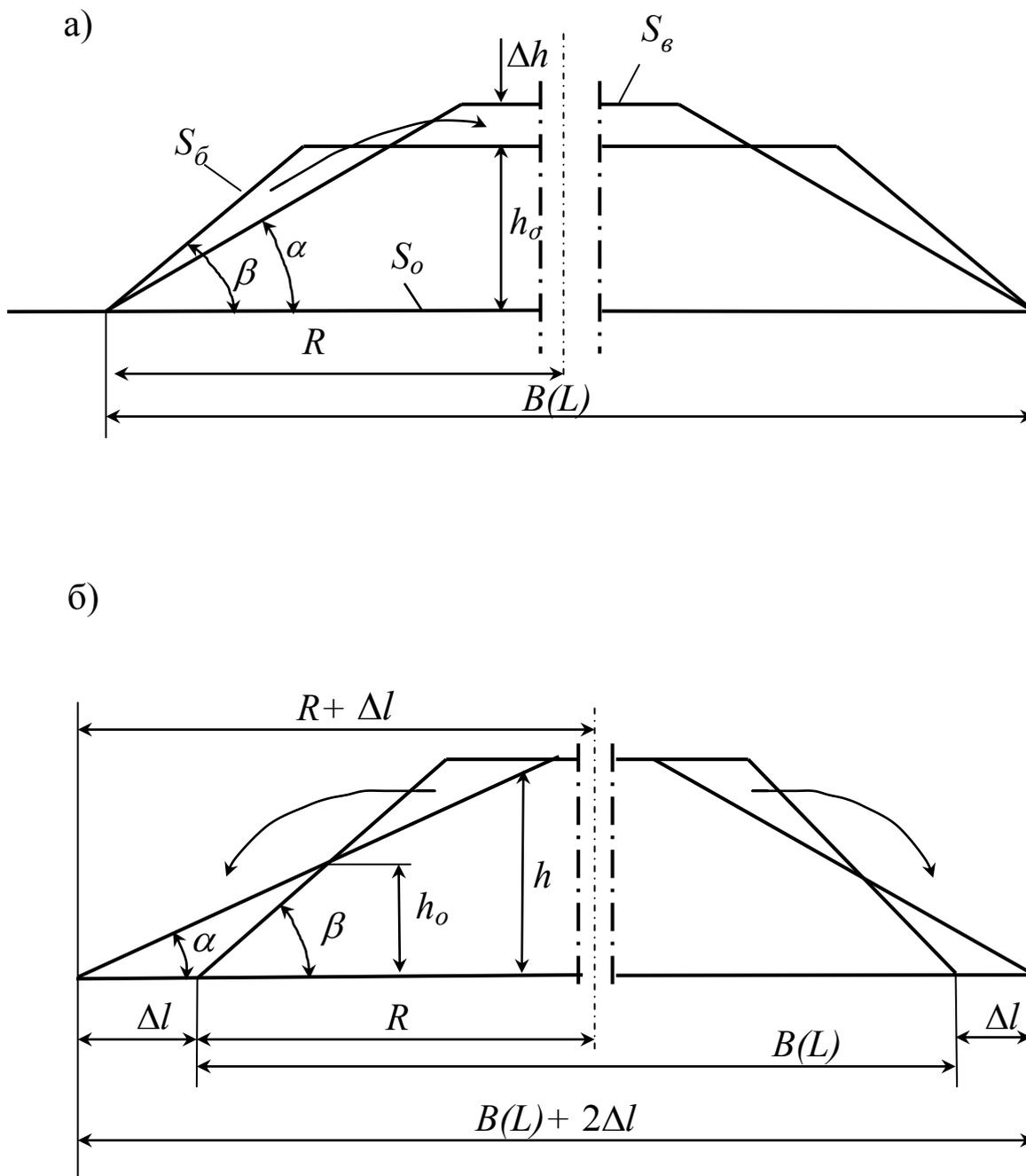
Рис. 1.3. Схемы выполаживания откосов отвала:
