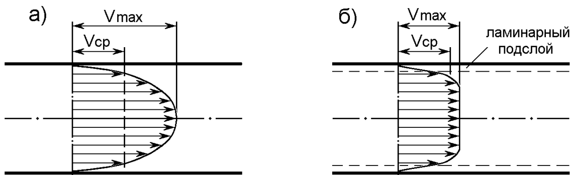
Рис. 19. Эпюры скоростей при ламинарном (а) и турбулентном (б) режимах движения жидкости
