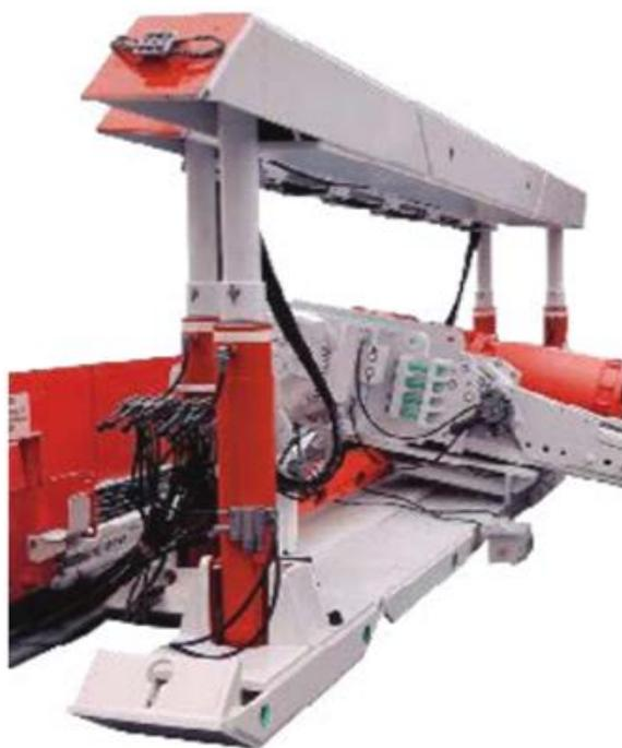
Рис. 2.10. Механизированная крепь сопряжения УКТ
