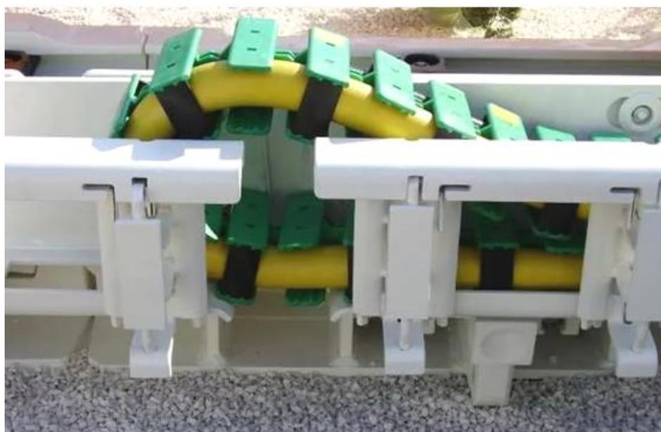
Рис. 2.25. Кабелеукладчик УКТ
