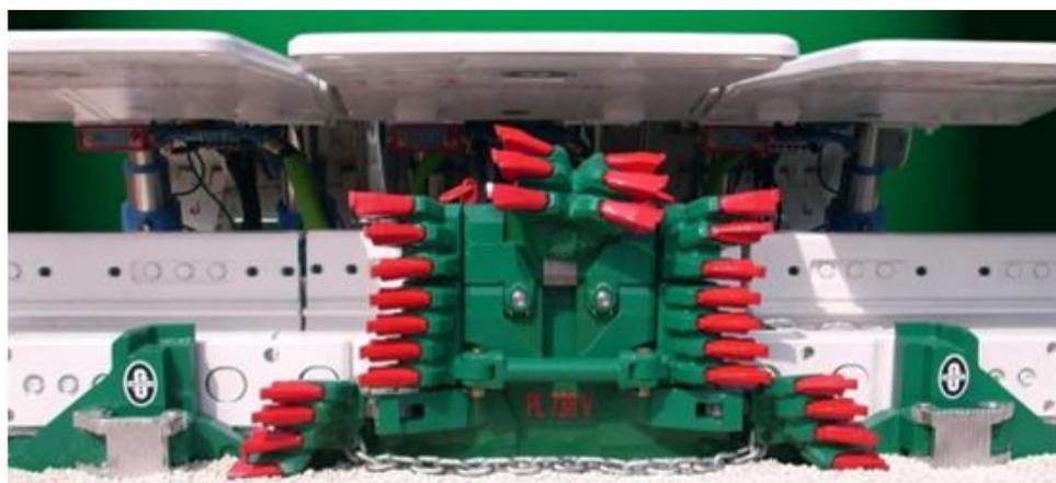
Рис. 2.17. Комплекс струговый механизированный PL738V
