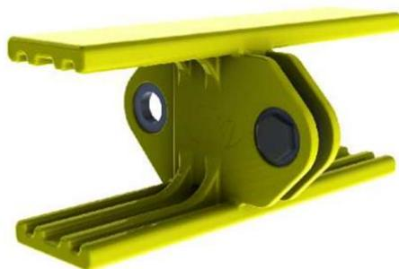
Рис. 2.24. Звено трака кабелеукладчика ТМКУО
