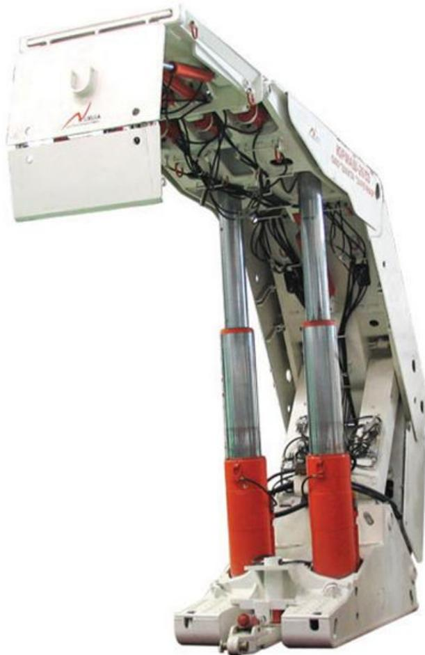
Рис. 2.6. Секции механизированной крепи 2Ш26/53
