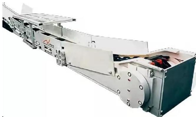
Рис. 2.29. Скребковый перегружатель ПС271
