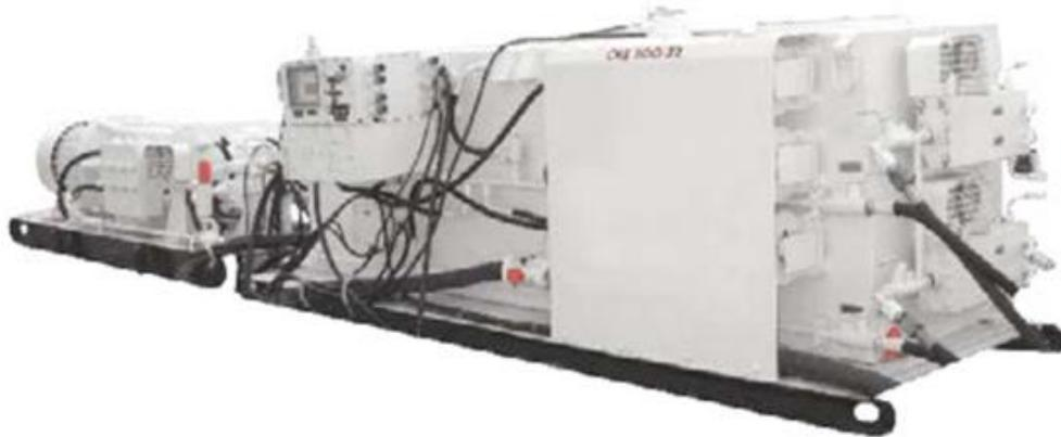
Рис. 2.36. Насосная станция СНД100/32
