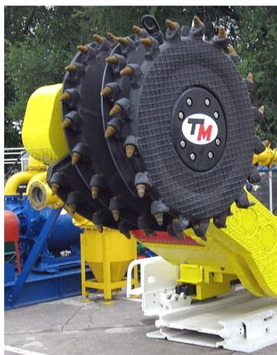
Рис. 2.38. Шнековый исполнительный орган очистного комбайна MB350E (Чехия)
