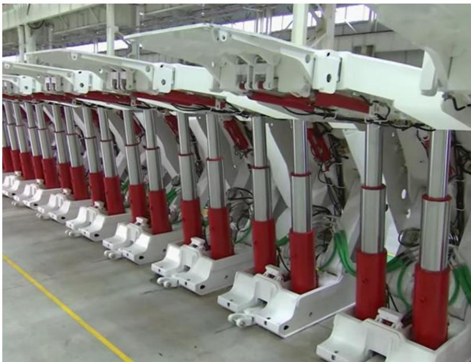
Рис. 2.4. Секции механизированной крепи ZMJ (Китай)
