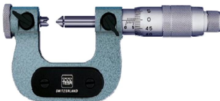
Рис. 12.9. Микрометр со вставками для измерения среднего диаметра резьбы
