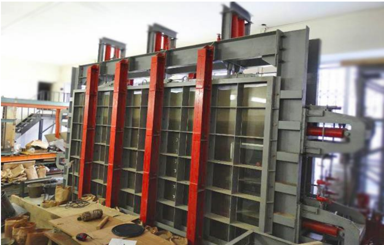
Рис. 1.6. Стенд для испытаний масштабных моделей подземных сооружений
