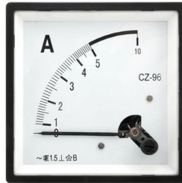
Рис. 14.6. Амперметр переменного тока электромагнитной системы
