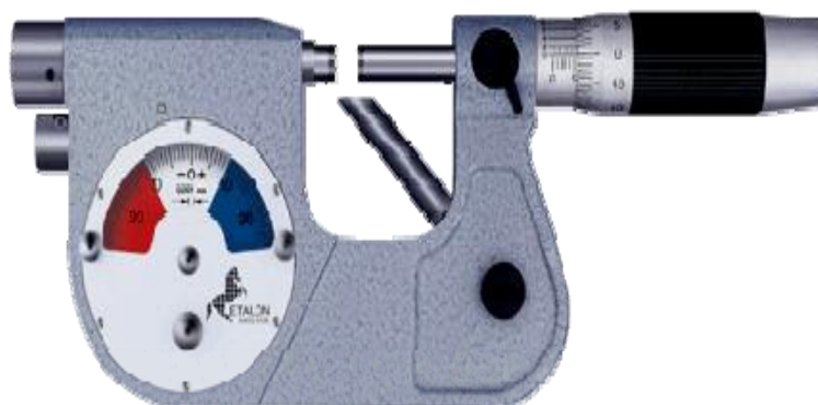
Рис. 12.11. Микрометр рычажный с отчетным устройством, встроенным в скобу
