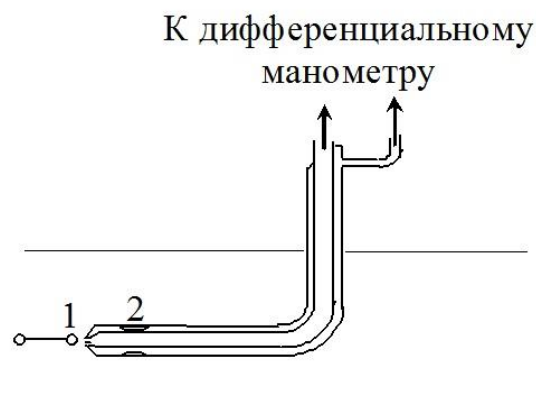
Рис. 5.5. Измерение скоростного напора с помощью трубки Пито – Прандтля
