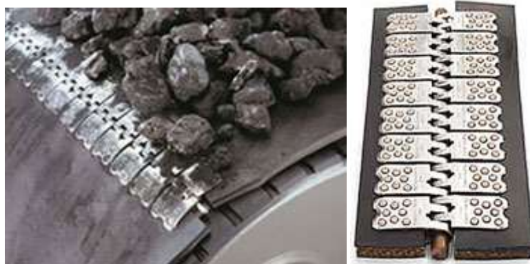
Рис. 3. Общий вид соединения конвейерной ленты
