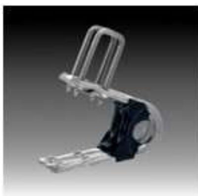
Рис. 16. Скоба серии U30, S30 S, E30 с полиуретановым уплотнением, предотвращающим просыпь транспортируемого материала
