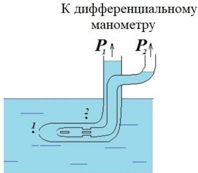
Рис. 3.6. Схема для измерения динамического давления с помощью трубки Пито – Прандтля
