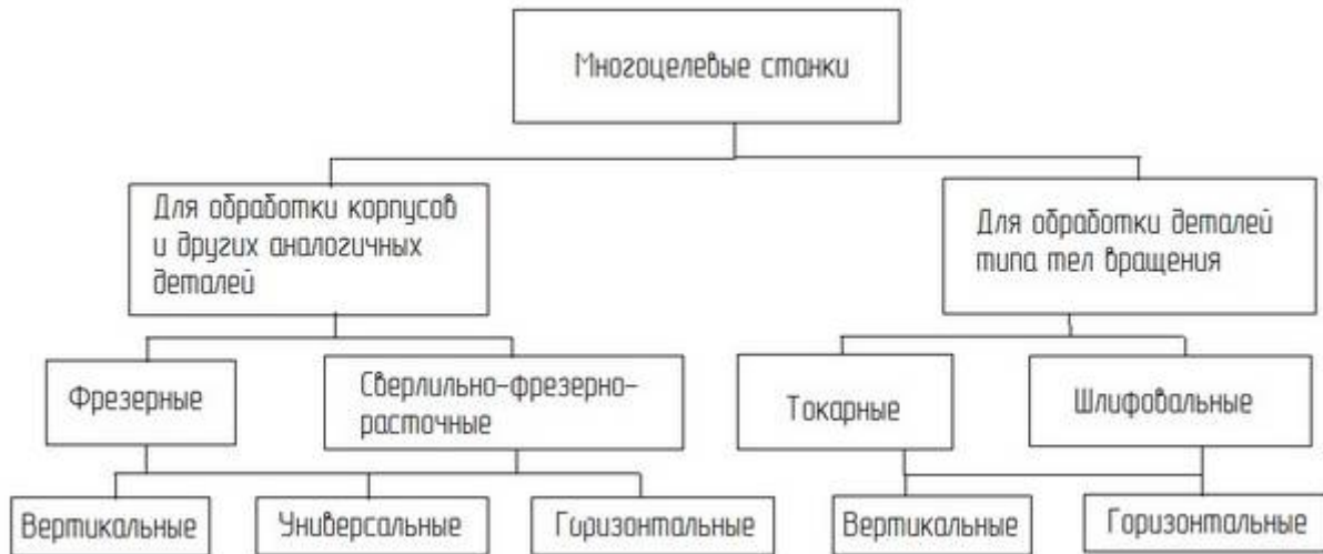
Рис. 54. Классификация обрабатывающих центров
