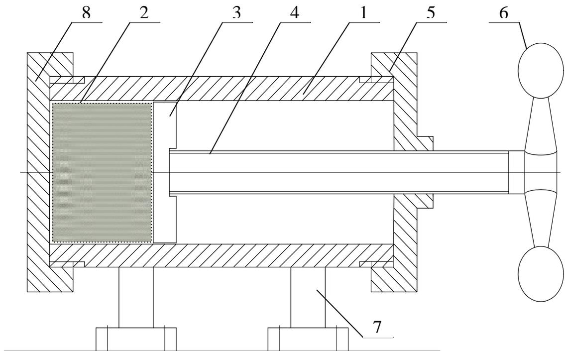
*Рис. 2. Схема установки для пелетирования: 1 – материальный цилиндр; 2 – исходная смесь для пелетирования; 3 – поршень; 4 – шток с винтовой нарезкой; 5 – задняя крышка; 6 – рукоятка; 7 – съемные опоры; 8 – передняя крышка*
