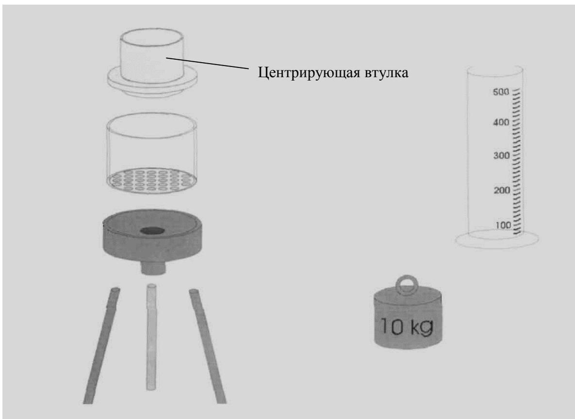
Рис. 3.1. Лабораторная установка для фильтрации под давлением.
