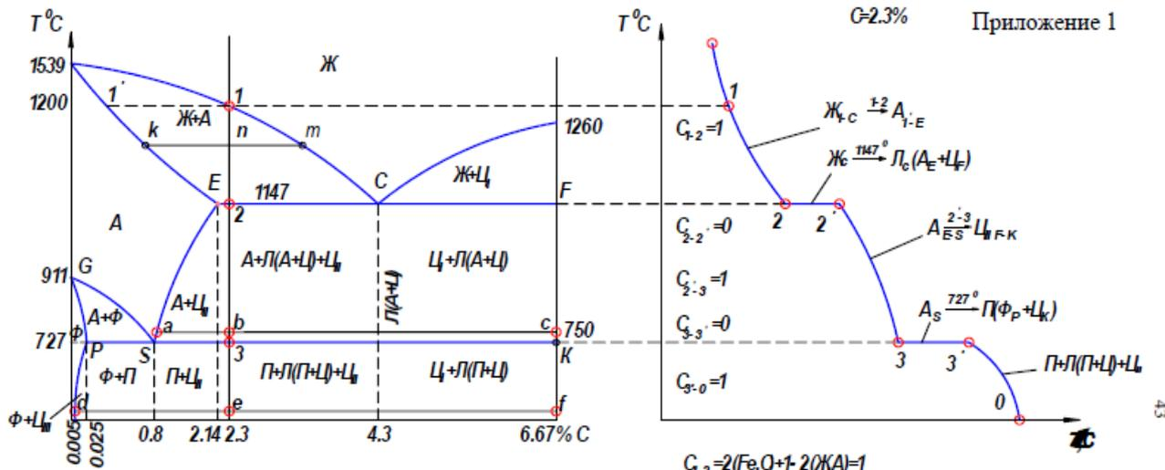
При  $T=1200\text{ }^{\circ}\text{C}$   $Q_A = \frac{nm}{km} 100\%$
