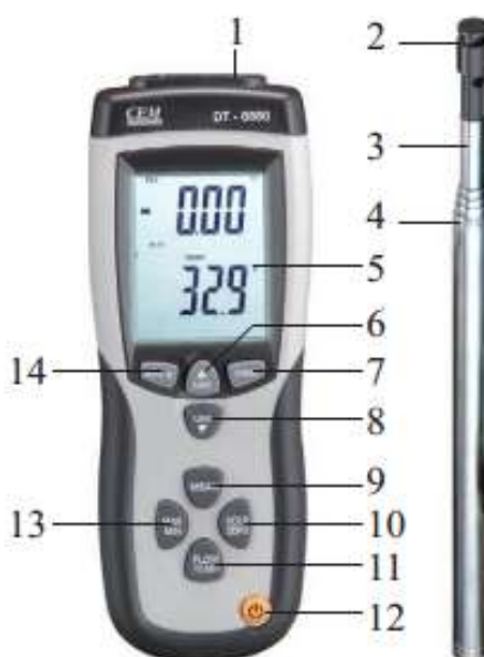
Рисунок 5. Элементы прибора: 1 – гнездо для подключения телескопического щупа; 2 – датчик температуры и скорости воздушного потока; 3 – защитный колпачок датчика температуры и влажности; 4- телескопический щуп; 5 – ЖК-дисплей; 6 – кнопка UNIT – переключение между пунктами меню, выбор единиц измерения; 7 – кнопка ENTER – вход в меню настройки параметра, подтверждение измерений; 8 – кнопка UNIT – переключение между пунктами меню, выбор единиц измерения; 9 – кнопка MEAN – расчет среднего значения измеряемой величины; 10 – кнопка HOLD/ZERO – удержание показаний на дисплее; 11 – кнопка FLOW/TEMP – переключение между отображением скорости воздушного потока и расходом воздуха; 12 – включение/выключение прибора; 13 – кнопка max/min – отображение максимальных/минимальных значений; 14 – кнопка Setup – вход в меню настройки прибора, включение/выключение подсветки
