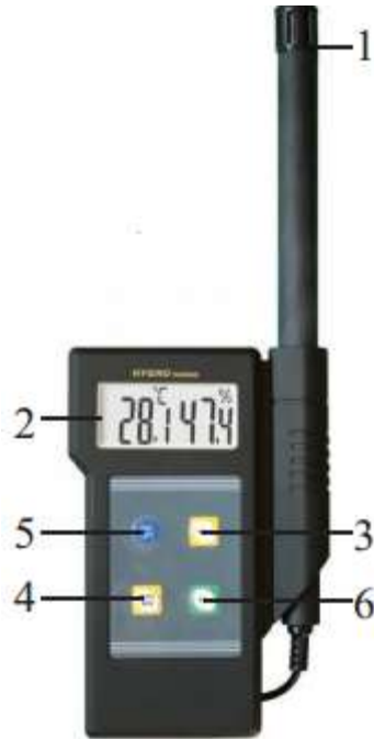
Рисунок 2: 1 – датчик температуры и влажности; 2 – ЖК-дисплей; 3 – кнопка F/C – выбор единиц измерения температуры; 4 – кнопка max/min – отображение максимальных/минимальных значений; 5 – кнопка on/off – включение/выключение прибора; 6 – кнопка В/L – включение подсветки
