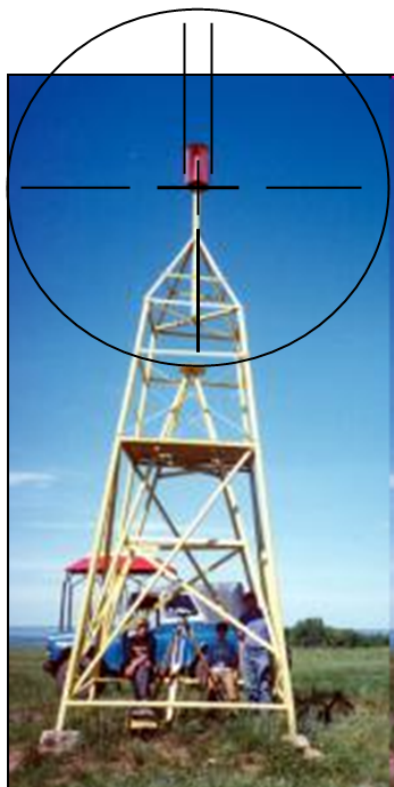
Рис. 5.28. Наведение сетки нитей на визирный цилиндр
