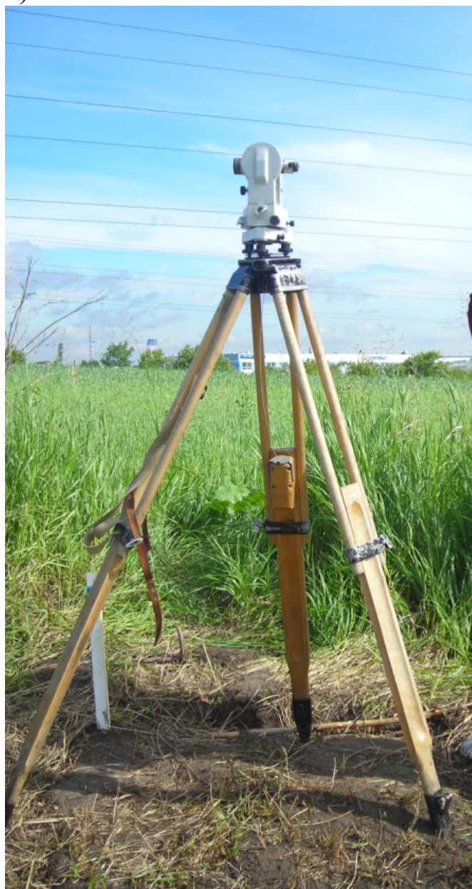
Рис. 5.12. а) Внешний вид теодолита 2Т30М на штативе; б) становой винт; в) груз нитяного отвеса
