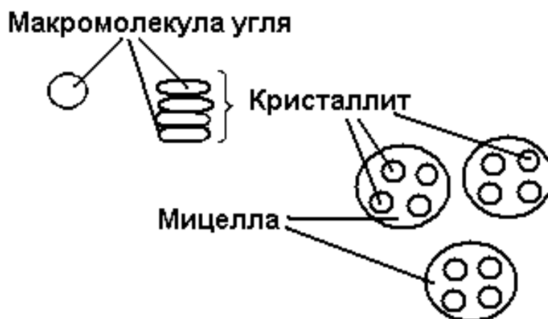
Рис. 2.2. Мицеллярная микроструктура каменного угля
