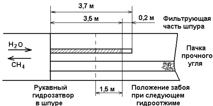
Рис. 3.10. Схема гидроотжима пласта для интенсификации метановыделения в остановленном забое подготовительной выработки (схема 4, б)
