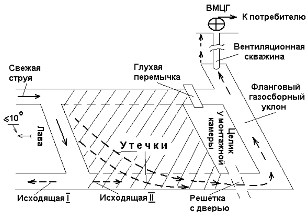
Рис. 3.3. Схема управления метановыделением с использованием вентиляционной скважины и газоотсасывающего вентилятора (схема 1, б)
