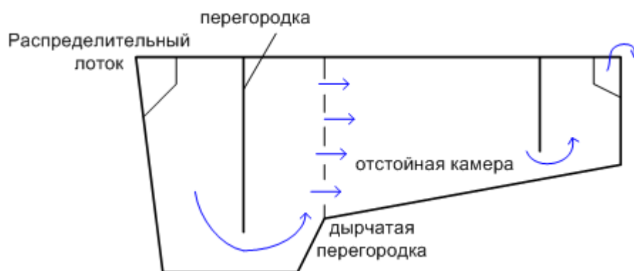
Рис. 9. Схема отстойника
