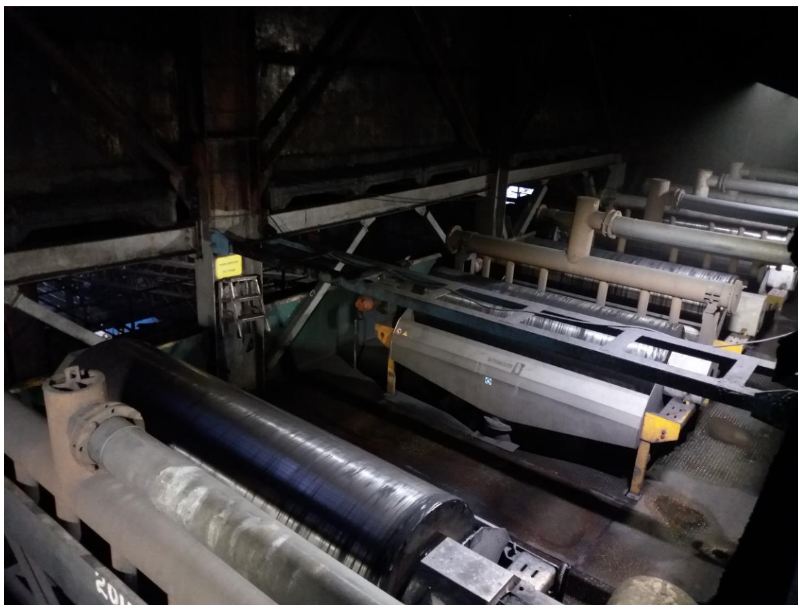
Рис. 3.3.1.2. Магнитные сепараторы для регенерации магнетитовой суспензии на Печорской ЦОФ
