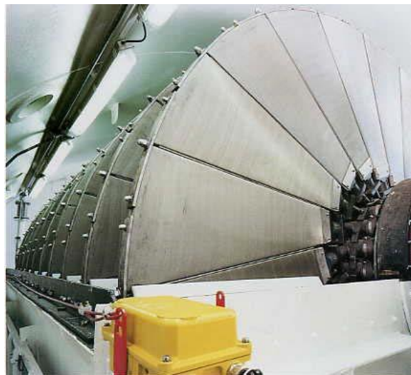
Рис. 4.1.6.4. Фильтры высокого давления фирмы «ANDRITZ»
