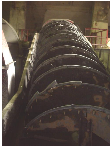
Рис. 2.2.1.1. Механический спиральный классификатор с непогруженной спиралью
