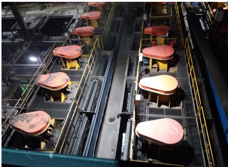
Рис. 3.2.2.2.3. Флотационные машины «WEMCO 144L» на ЦОФ «Печорская»
