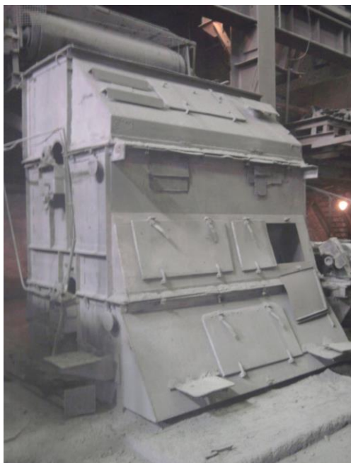
Рис. 3.3.1.1. Магнитный сепаратор. Дробильно-обогащительная фабрика (п. Шерегеш). Обогащение магнетитовых руд
