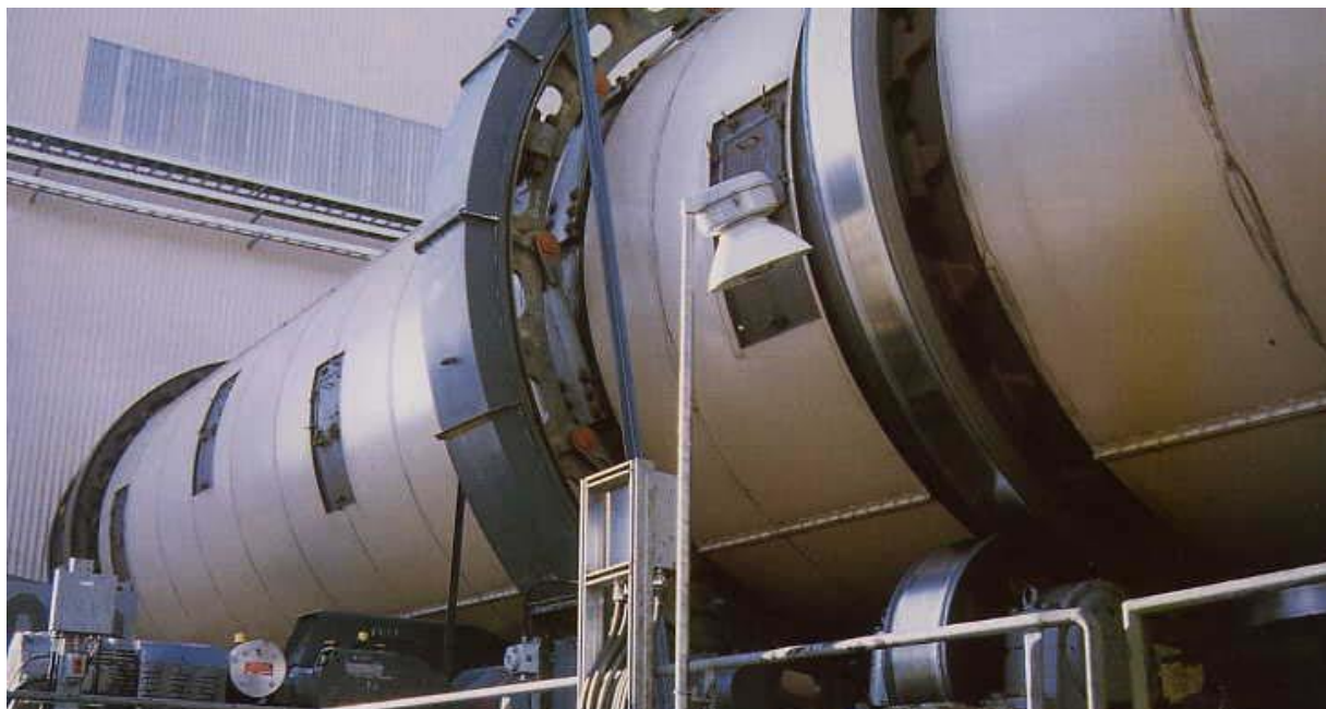
Рис. 4.1.7.2. Барабанная прямоточная сушилка
