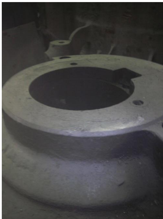
Рис. 2.3.4.2.3. Верхняя часть эксцентрикового стакана (вала-эксцентрика) с конической расточкой со смещенной осью
