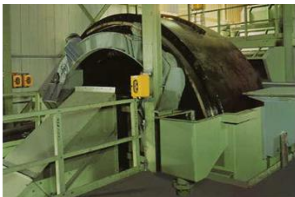
Рис. 3.1.3.3.2. Отсадочная машина с подвижным решетом РОМДЖИГ (МВЕ)
