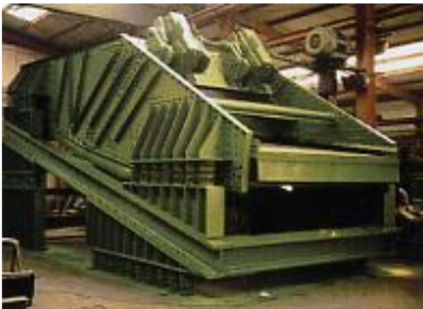
Рис. 4.1.3.1. Грохот инерционный с самобалансным самосинхронизирующимся вибратором
