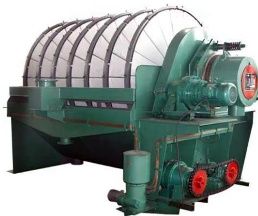
Рис. 4.1.6.3. Дисковый вакуум-фильтр фирмы «ANDRITZ»
