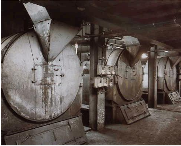
Рис. 4.1.5.3. Центрифуга фильтрующая вибрационная HSG-1100
