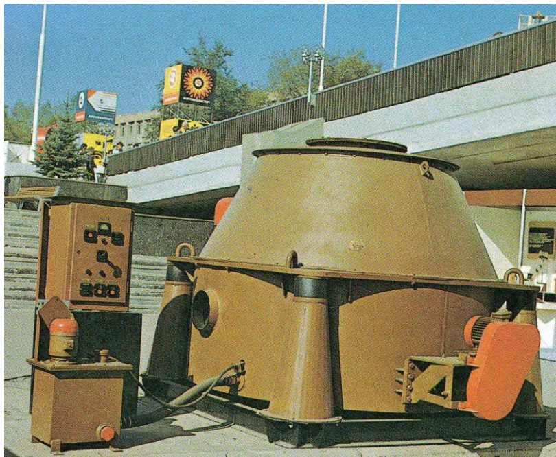
Рис. 4.1.5.1. Центрифуга фильтрующая вертикальная шнековая ФВШ-100С-1
