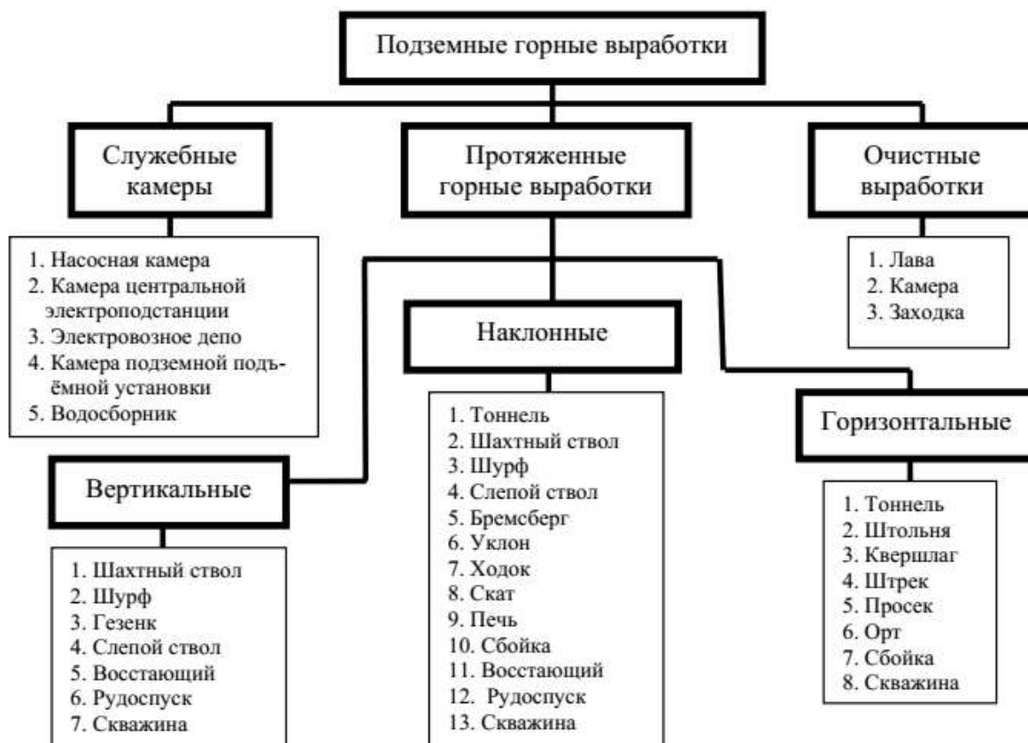
Рис. 1.1. Классификация подземных горных выработок
