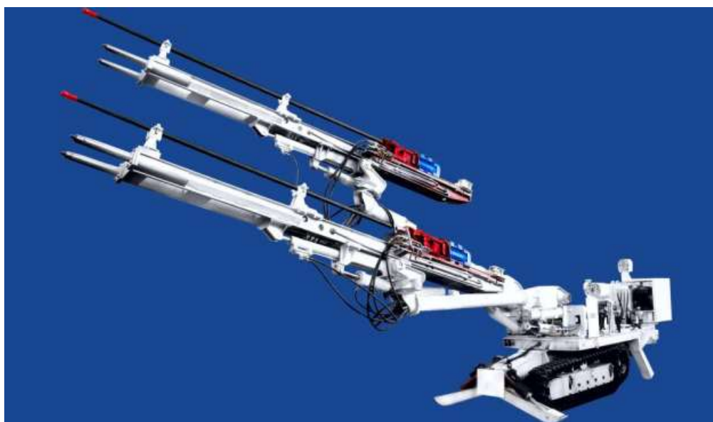
Рисунок 5.6. Бурильная установка УБШ 313А
