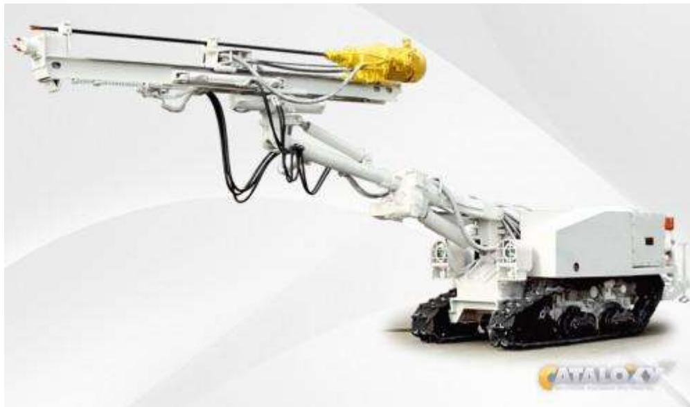
Рисунок 5.4. Бурильная установка УБШ-210А
