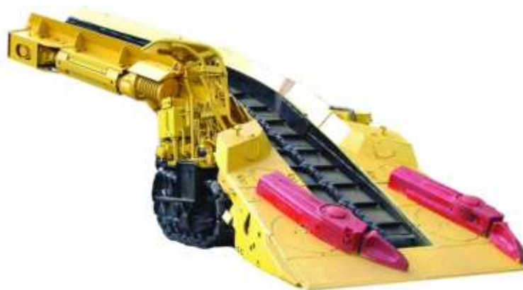
Рисунок 5.9 Общий вид погрузочной машины непрерывного действия с рабочим органом «загребающие лапы»
