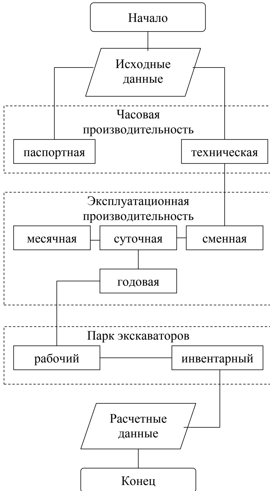
Рис. 1.2. Алгоритм расчета производительности и инвентарного парка экскаваторов
