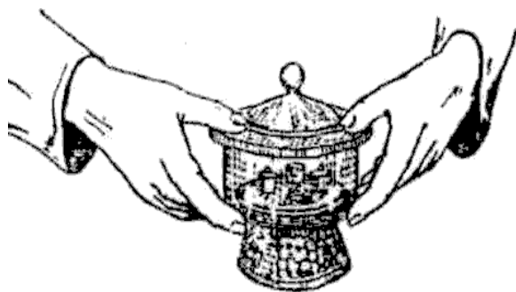
Рис. 7. Положение рук при переноске эксикатора
