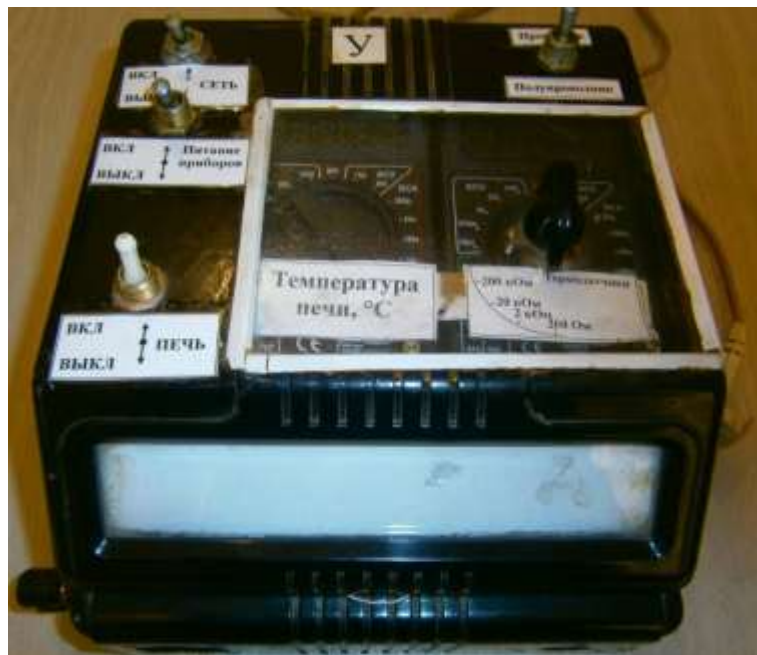
Рис.1. Установка для изучения зависимости сопротивления металлов и полупроводников от температуры
