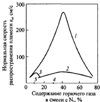
Рис. 5. Зависимость нормальной скорости распространения пламени от состава смеси:
