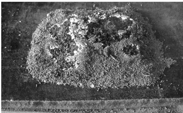
Рис. 11. беспламенное горение сахара на оксиде хрома
