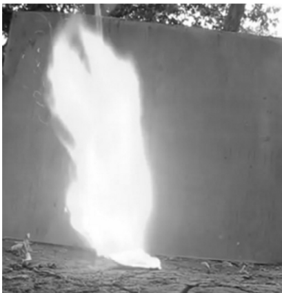
Рис. 8. Взрывное горение бездымного пороха
