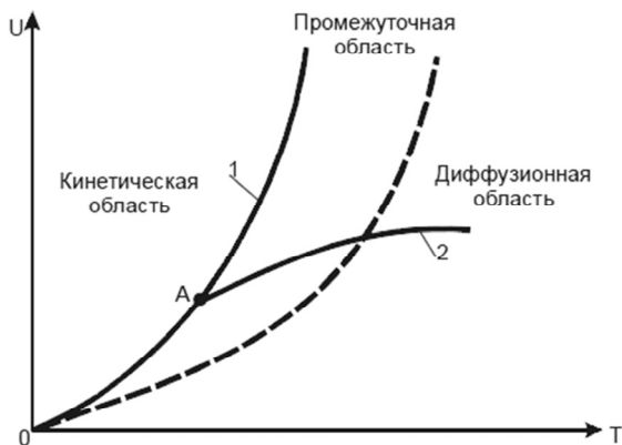
Рис. 5. Зависимость скорости горения от температуры:
