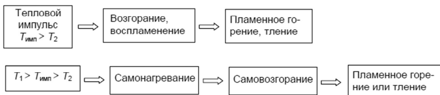
Рис. 26. Схемы процессов возгорания и самовозгорания
