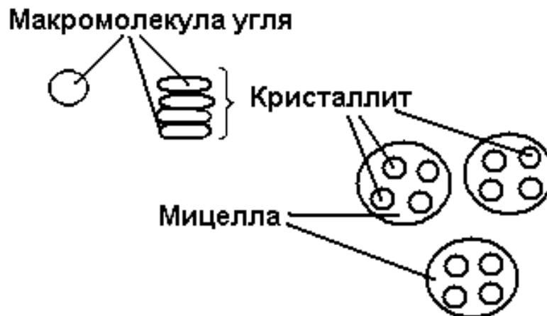
Рис. 2.2. Мицеллярная микроструктура каменного угля
