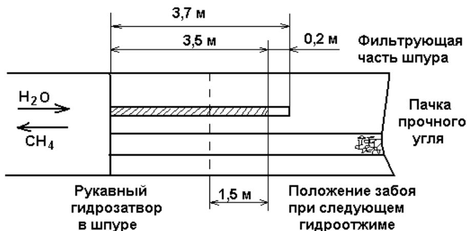
Рис. 3.10. Схема гидроотжима пласта для интенсификации метановыделения в остановленном забое подготовительной выработки
