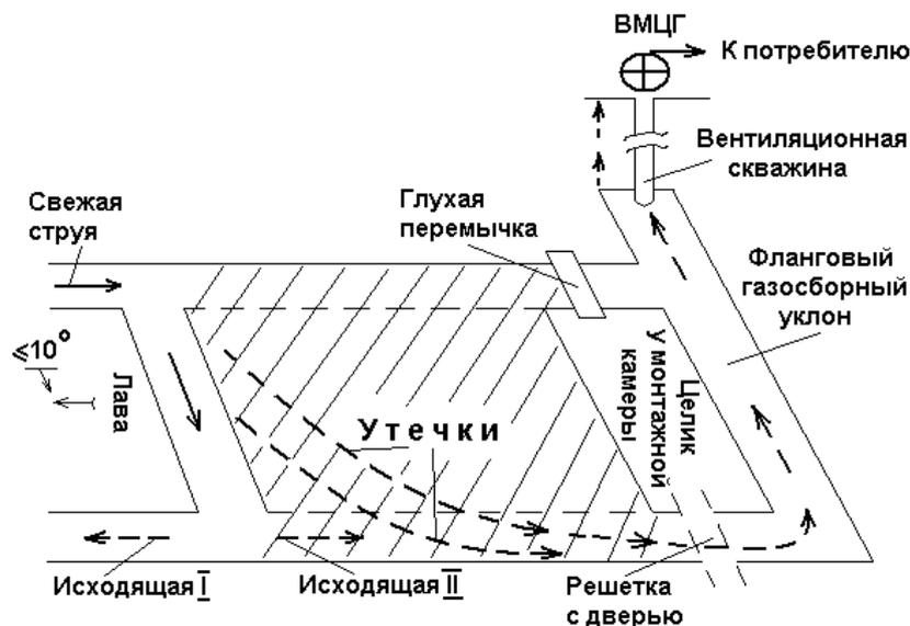
Рис. 7.3. Схема управления метановыделением с использованием вентиляционной скважины и газоотсасывающего вентилятора
