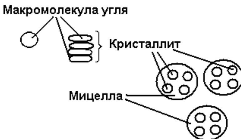
Рис. 1.2. Мицеллярная микроструктура каменного угля
