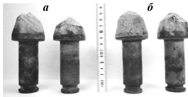
Рис. 9.20. Характер износа резцов РШ33-85/17,5
