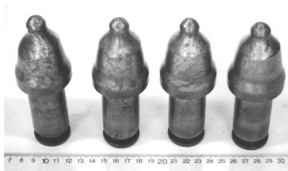
Рис. 9.22. Характерная сеть мелких трещин в армировке резца РШ32-70/16SK
