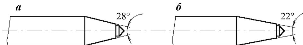
Рис. 12.9. Конструкция резца РКС-1, изготовленная по традиционной (а) и новой (б) технологиям
