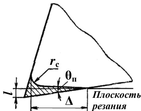
Рис. 9.1. Характеристики износа режущих инструментов
