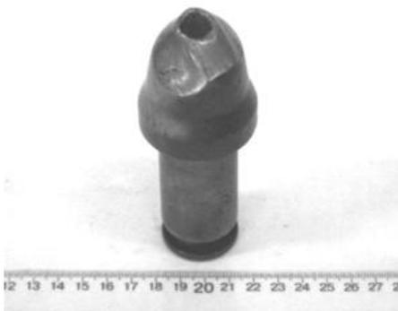
Рис. 9.21. Износ резца РШ32-70/16SK: оторвана вставка и изношена головка
