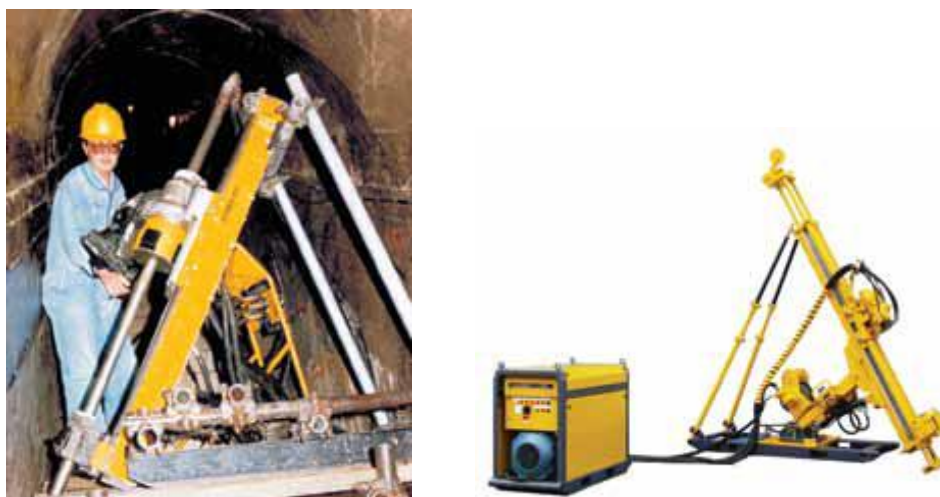
Рис. 2.11. Подземная буровая установка Diames
