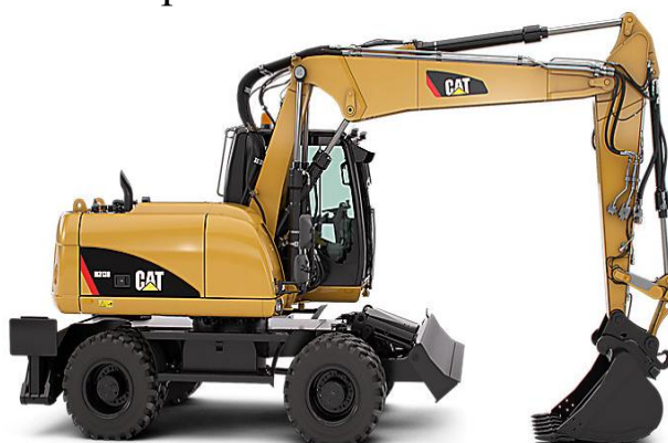
Рис. 3.31. Экскаватор пневмоколесный малой мощности
