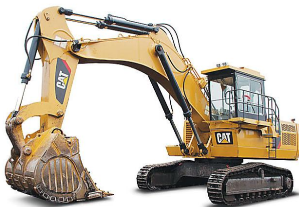
Рис. 3.30. Экскаватор гусеничный малой мощности
