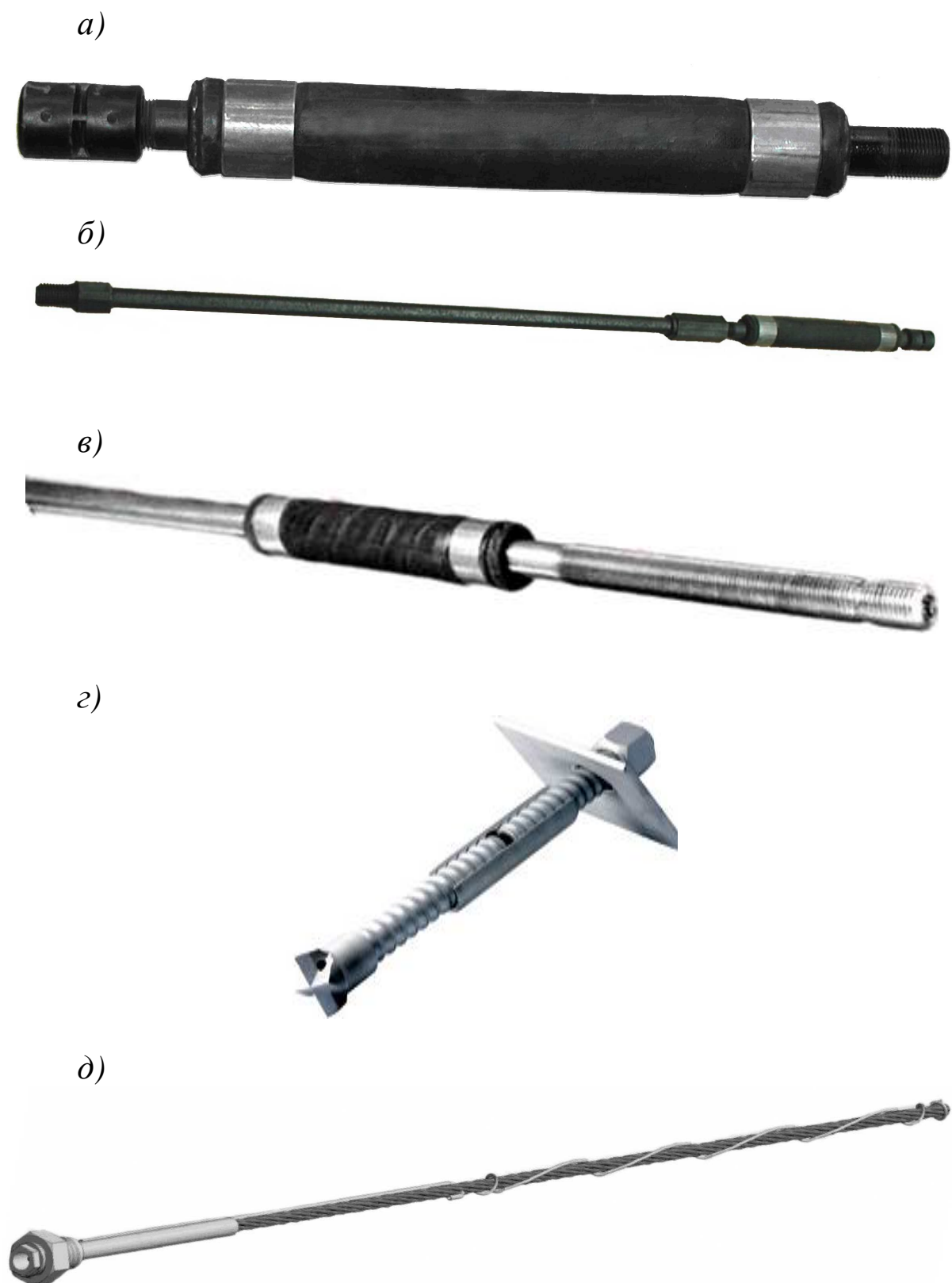
Рис. 8.1. Инъекционные анкеры и приспособления для нагнетания состава: а – герметизатор; б – герметизатор с пластиковой трубкой; в – нагнетательная трубка с функцией анкера; г – самонарезающий инъекционный анкер; д – канатный анкер с герметизатором
