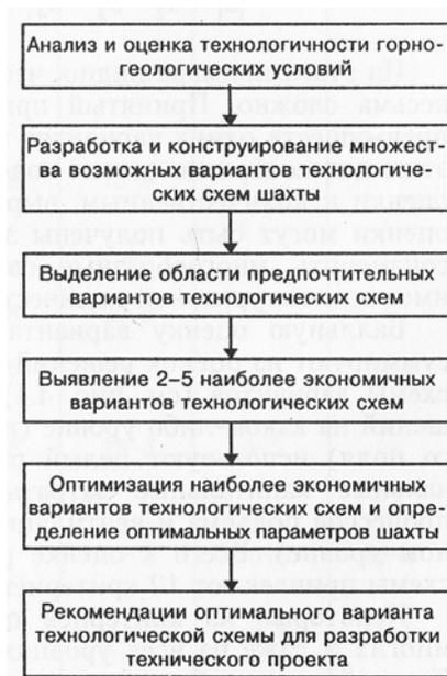
Рис. 6.1. Последовательность процесса оптимизации параметров шахты
