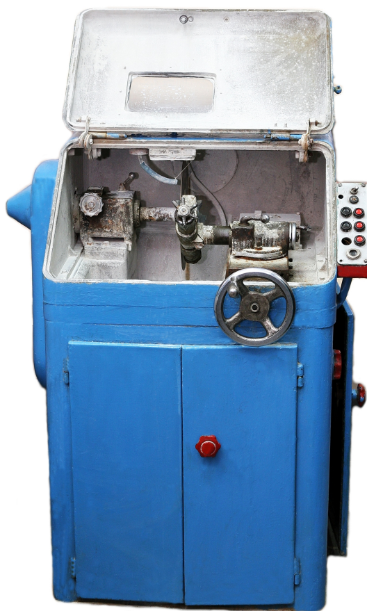
Рис. 1.2 – Камнерезный станок САСП-1 с алмазным режущим диском
