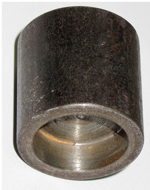
Рис. 3.15 – Кольцевой штамп (пуансон) испытательного устройства
