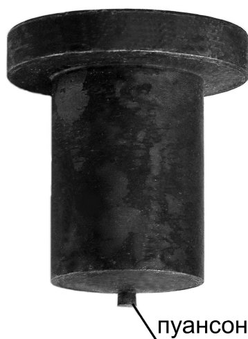
Рис. 6.3 – Общий вид стального цилиндра с пуансоном для определения контактной прочности пород
