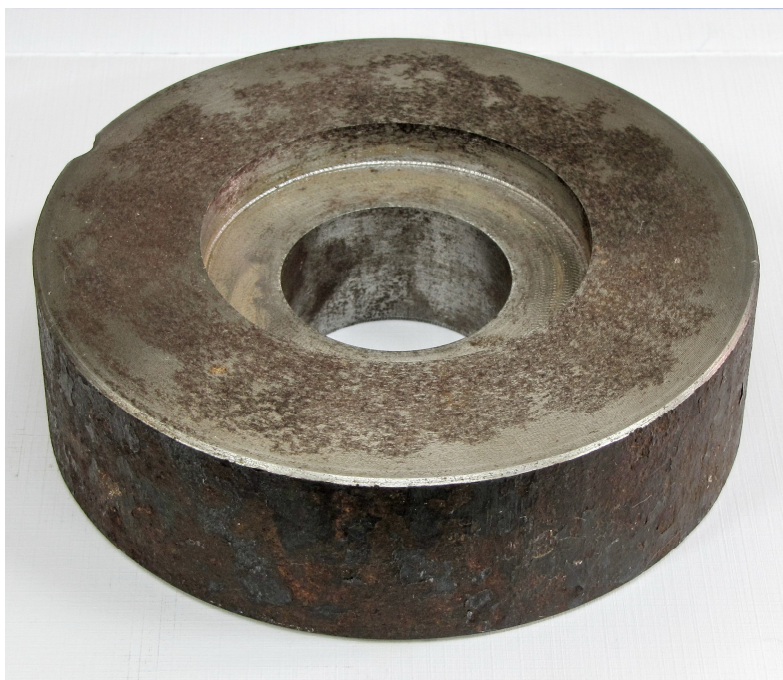
Рис. 3.14 – Стальное опорное кольцо испытательного устройства
