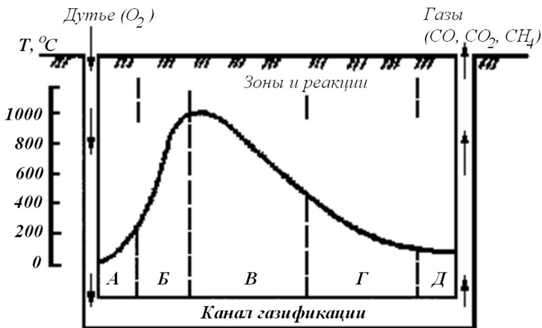
Рис. 6.10. Изменение температуры процессов и характера химических реакций по длине канала газификации и зонам: нагрева пласта (А), окисления (Б), восстановления (В), конверсии (Г), сушки газов и пласта (Д)
