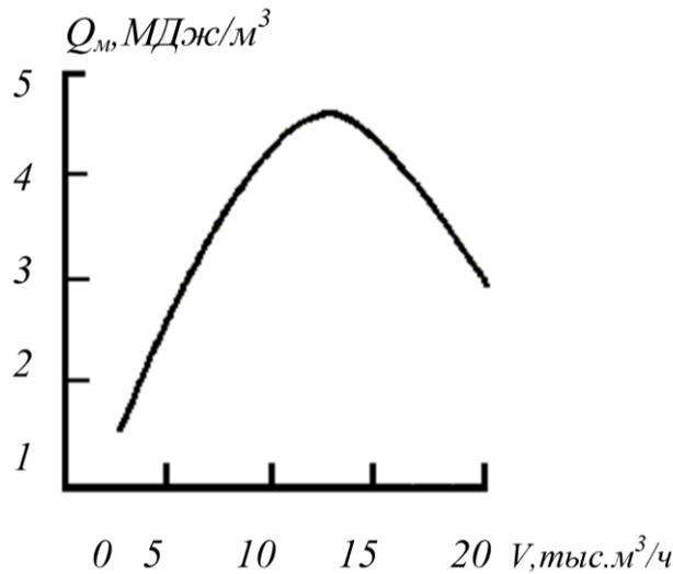
Рис. 6.12. Зависимость нижней теплоты сгорания газа  $Q$  от подачи дутья  $V$  на Южно-Абинской станции ПГУ
