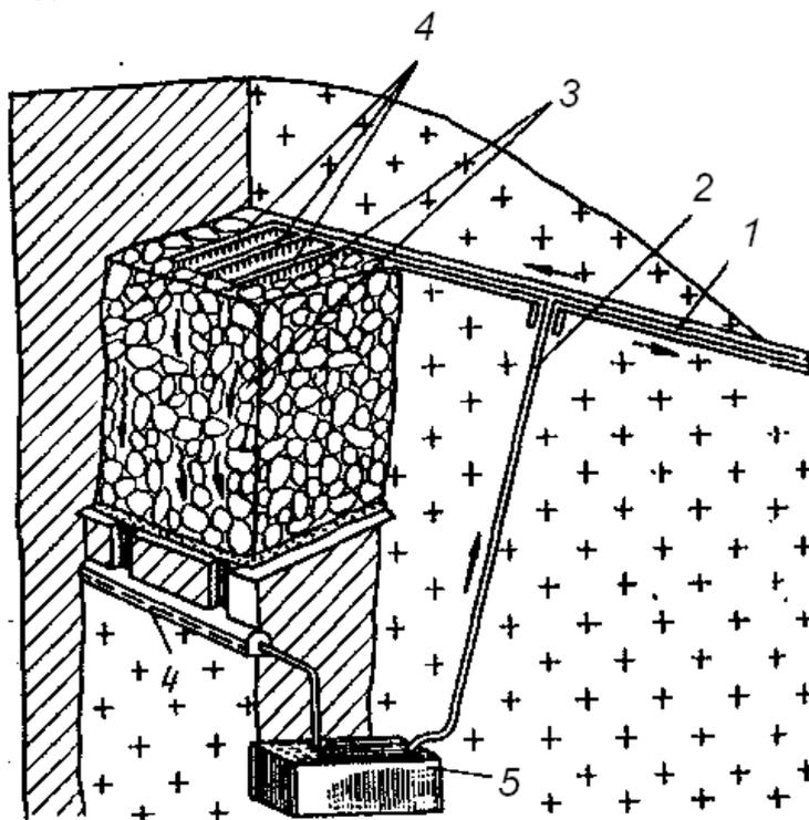
Рис. 6.3. Схема подземного выщелачивания с использованием горных выработок:
