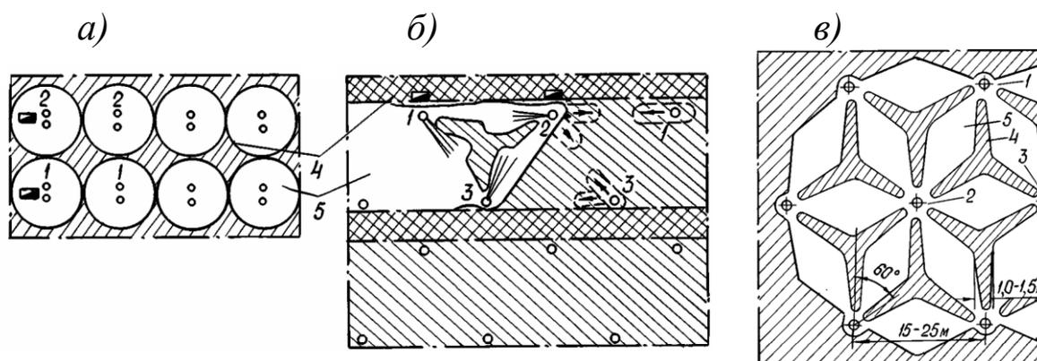
Рис. 6.8. Варианты систем разработки скважинной гидродобычи с открытым очистным пространством:
