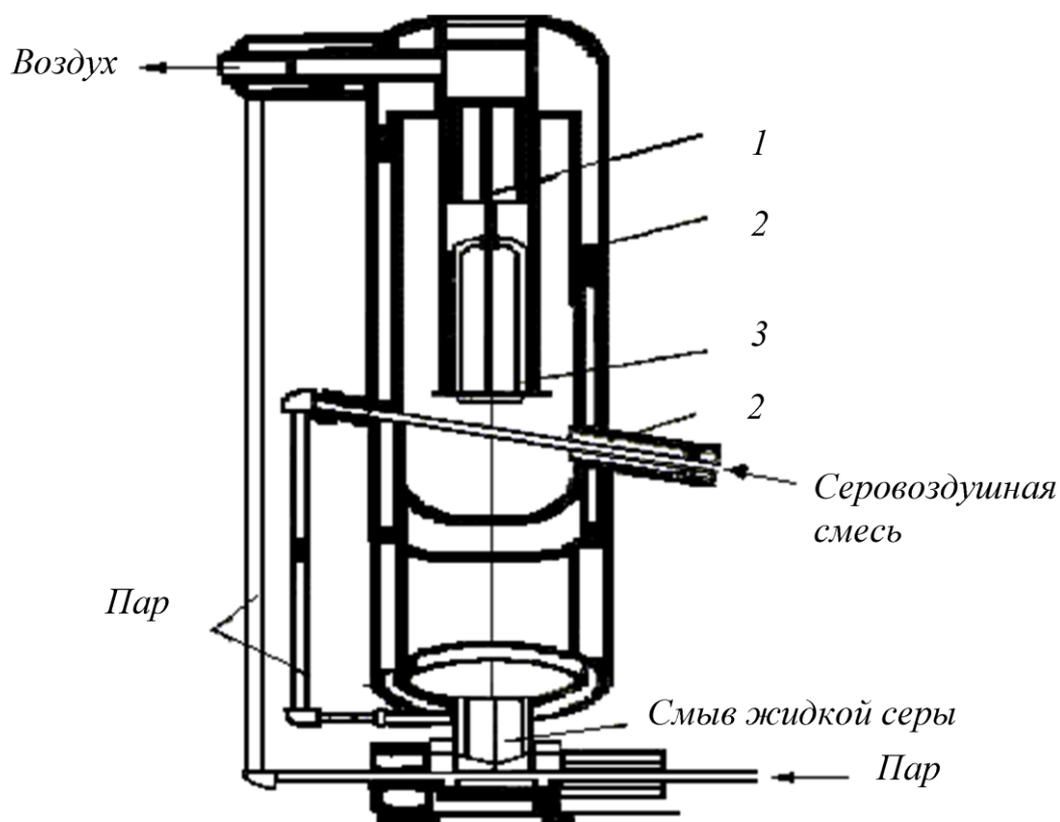
Рис. 4.2. Схема газового сепаратора
