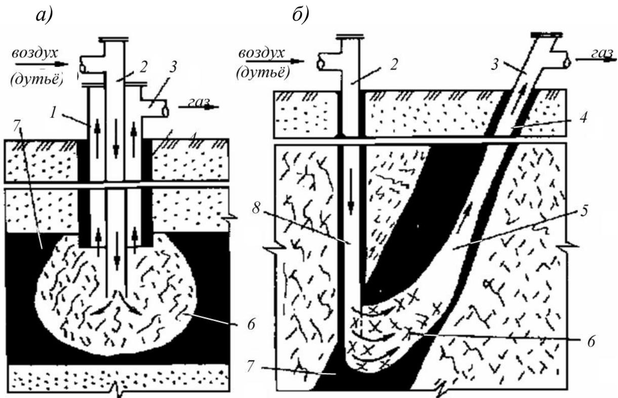
Рис. 6.13. Схемы подземной бесшахтной (скважинной) газификации угля отдельными скважинами (а) и взаимодействующими скважинами на крутом падении (б):
