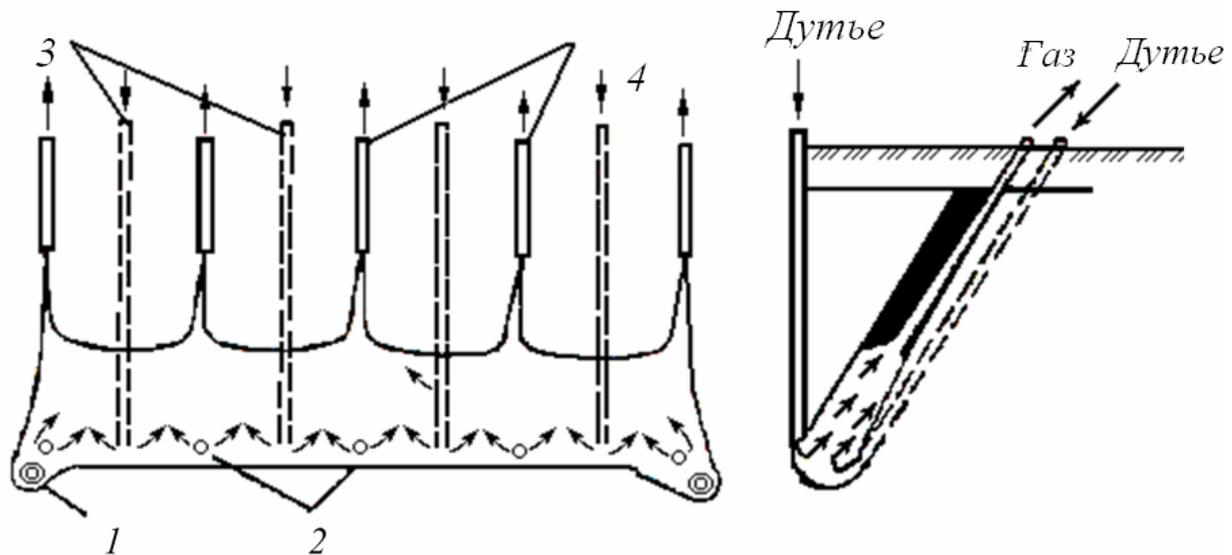
Рис. 6.14. Принципиальная схема газогенератора на угольных пластах:
