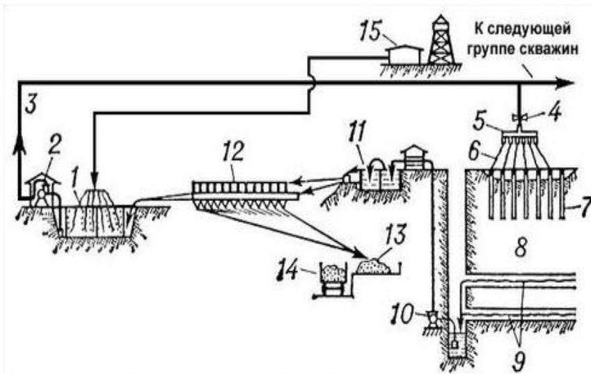
Рис. 6.4. Схема подземного бактериального выщелачивания медной руды:
