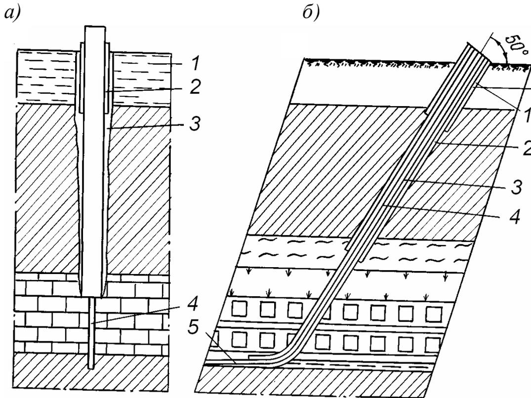
Рис. 5.1. Принципиальные схемы вскрытия месторождения отдельными скважинами
