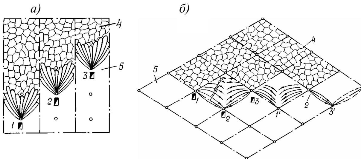
Рис. 6.9. Варианты разработки скважинной гидродобычи с обрушением или плавной посадкой вмещающих пород:
