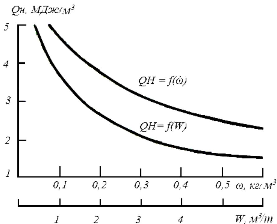
Рис. 6.11. Расчетная зависимость нижней теплоты сгорания газа  $Q_n$  от его влагосодержания  $\omega$  и удельного водопритока к пласту  $W$
