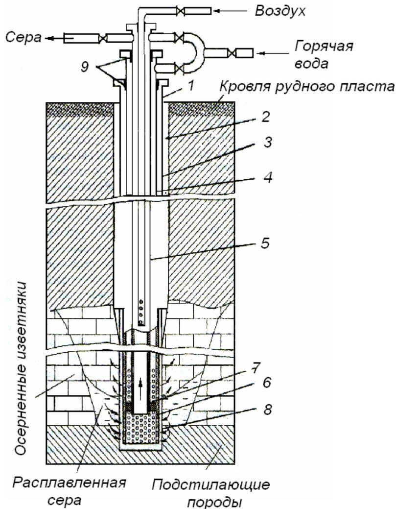
Рис. 6.5. Принципиальная схема добычной скважины при способе ПВС
