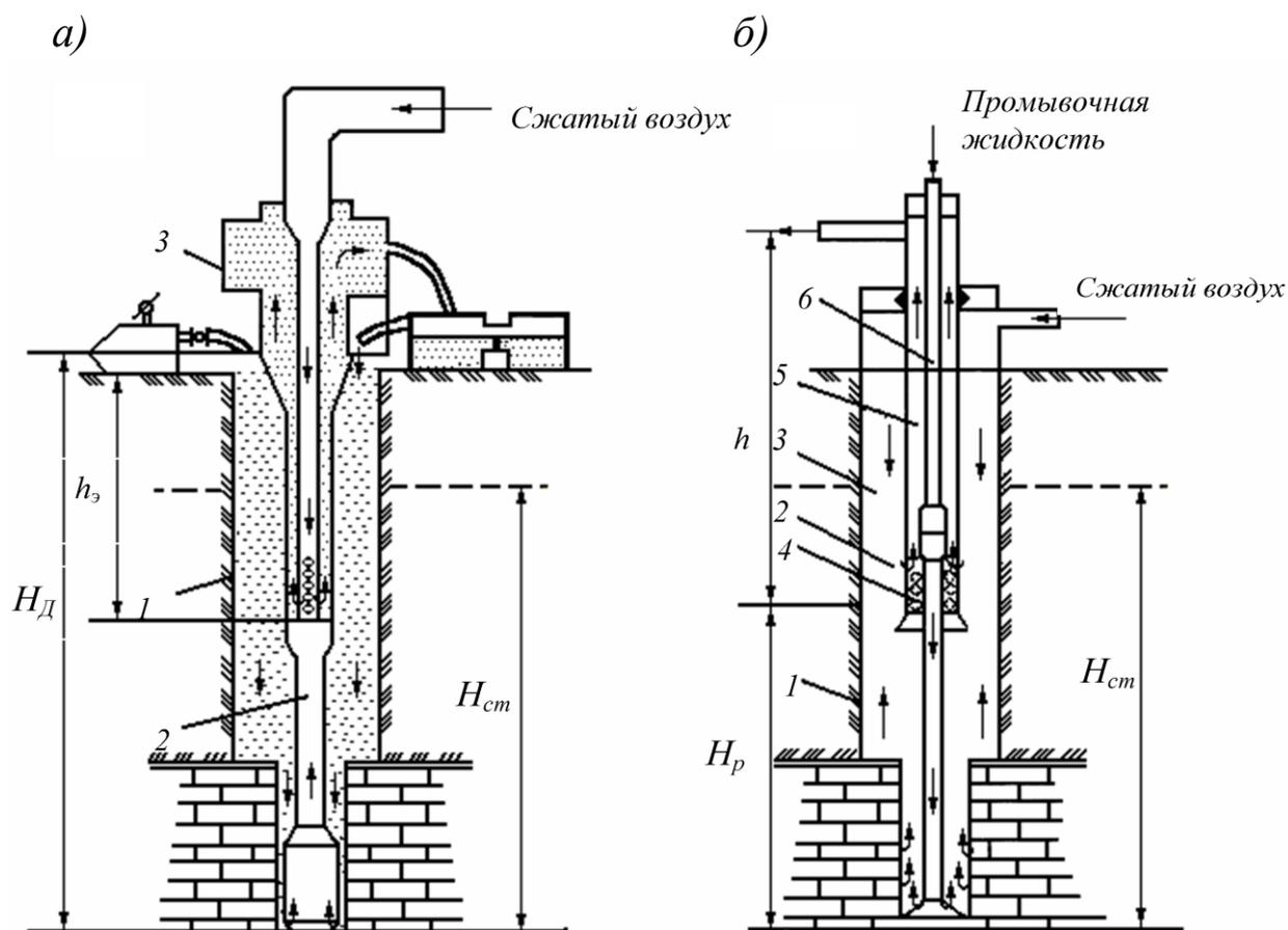
Рис. 4.1. Схемы бурения, используемые при бурении геотехнологических скважин:
