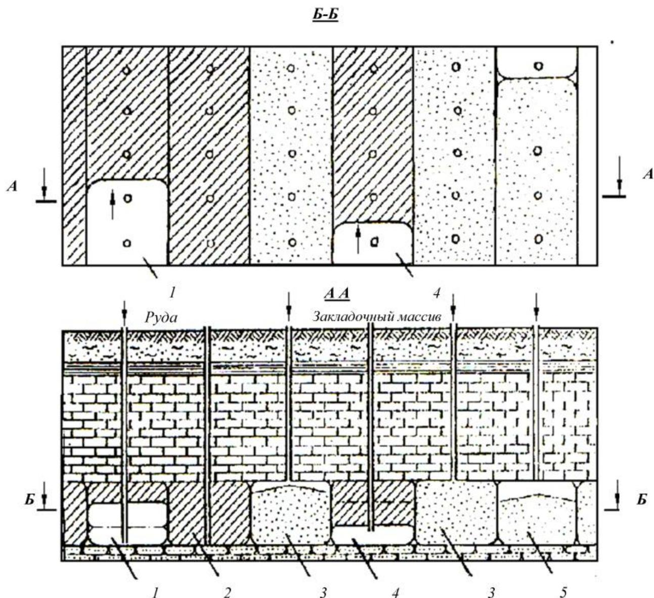
Рис. 4.4. Принципиальная схема отработки залежи с закладкой выработанных блоков
