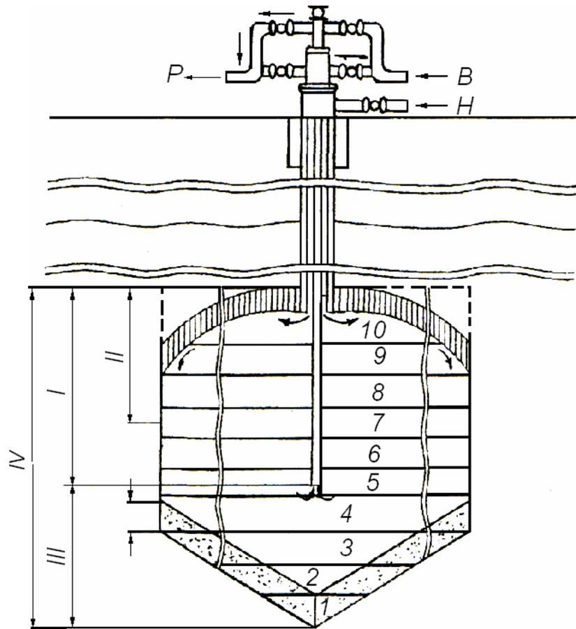
Рис. 6.1. Принципиальная схема послойной выемки камер при подземном растворении солей
