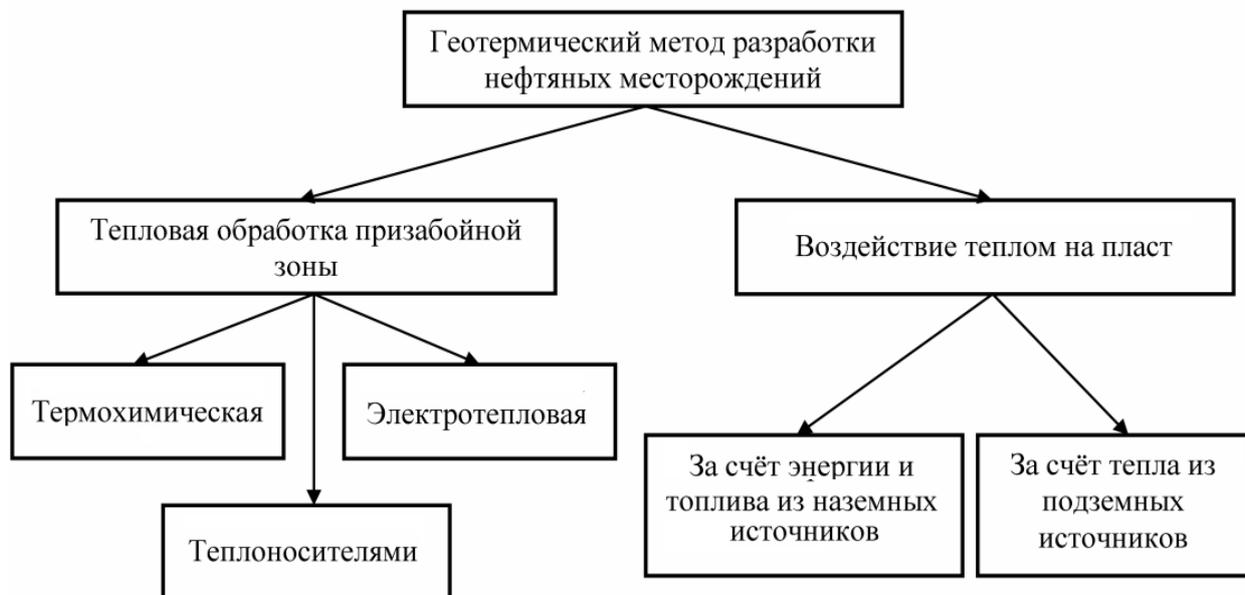
Рис. 6.6. Геотермические методы разработки нефтяных месторождений (по А. Б. Шейнману)
