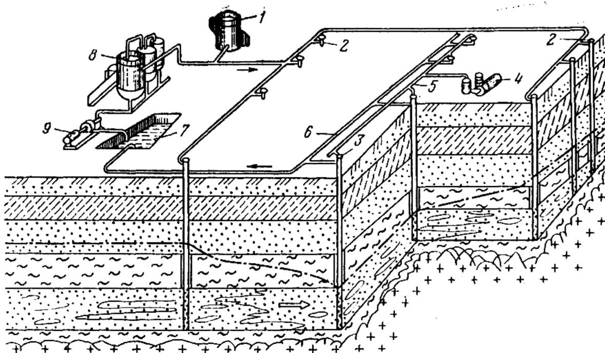
Рис. 6.2. Схема отработки пластового месторождения выщелачиванием через скважины:
