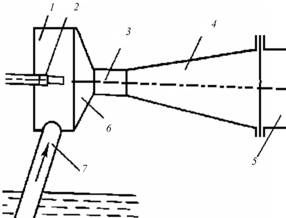
Рис. 4.3. Принципиальная схема гидроэлеваторного подъема
